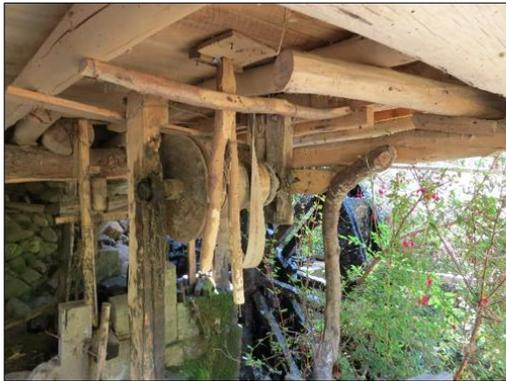
Figura 32: Molino de Pañul en donde se observa el sistema de engranaje del molino, además se distingue una cama de pircas y piedras de diferentes tamaños y bloques de cemento próximos a los pilares de madera. Fuente: Autora, 2015.
