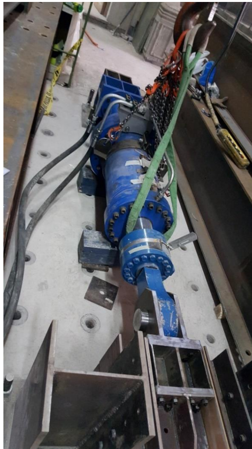
Figura 5.1: Instalación actuador hidráulico.
