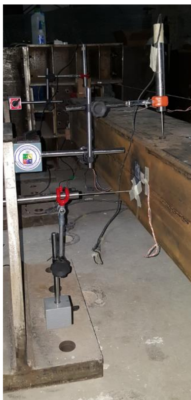
Figura 5.10: Instalación sensores de desplazamiento fuera del plano cara superior.
