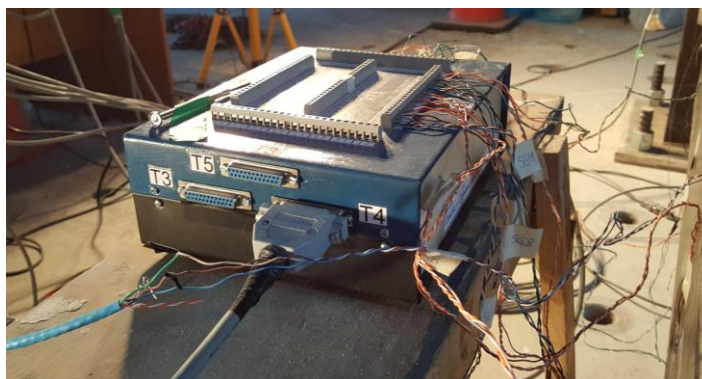
Figura 5.6: Conexión strain gages al sistema de adquisición.
