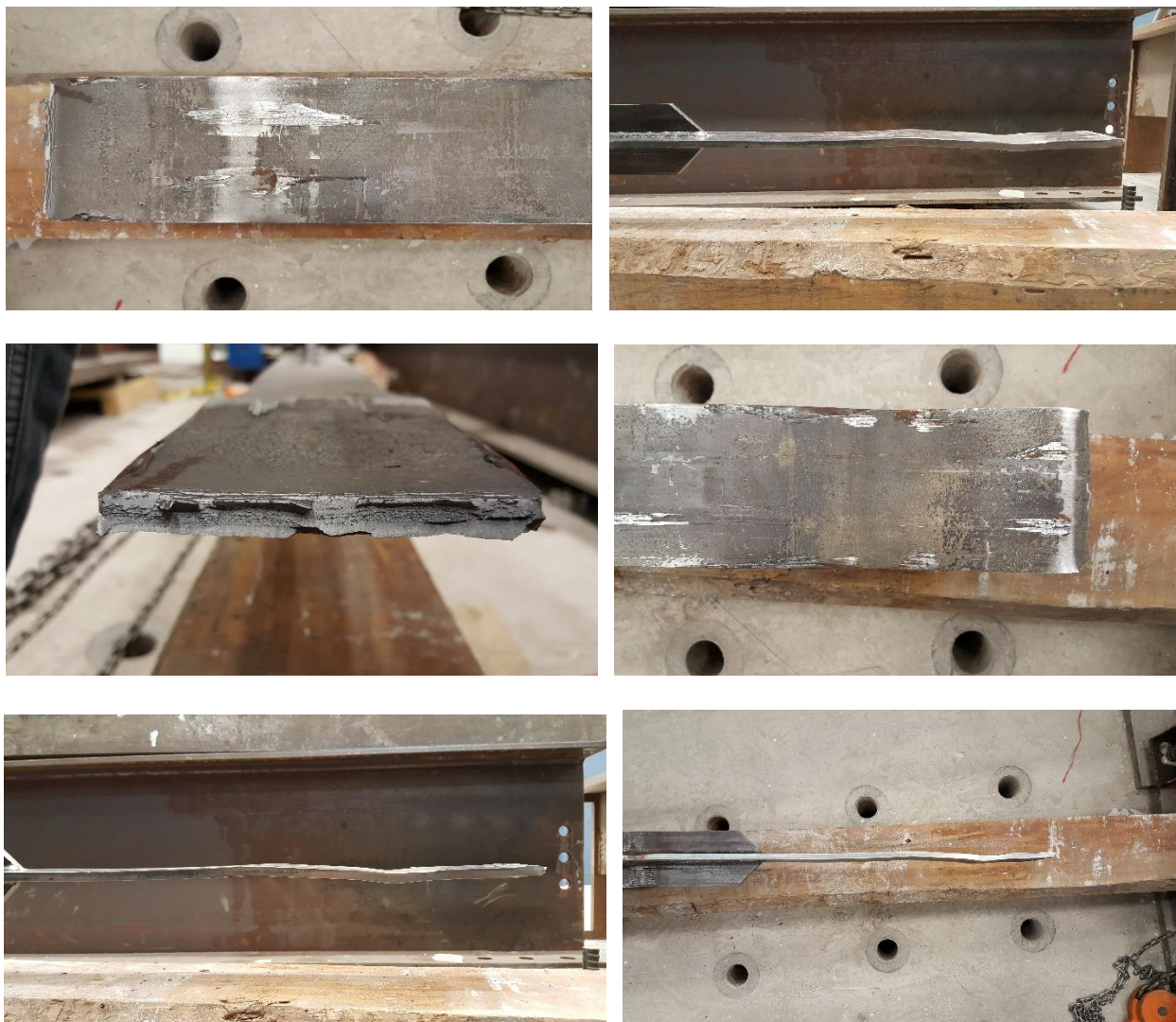
Figura 6.3: Fractura núcleo de acero prototipo C.
