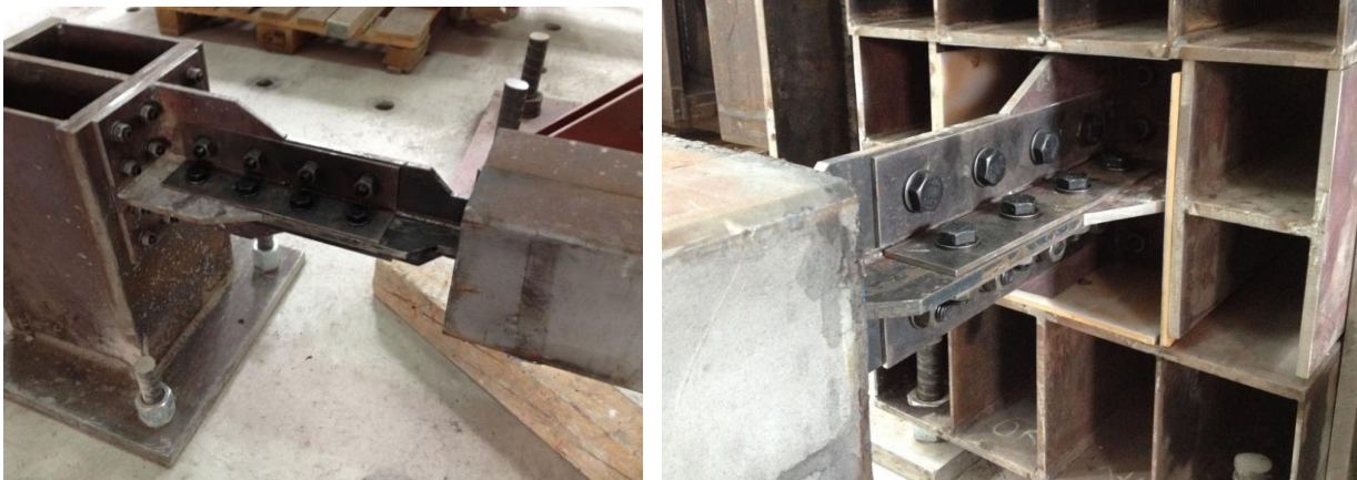
Figura 5.4: Unión apernada arriostramiento y placa Gusset.
