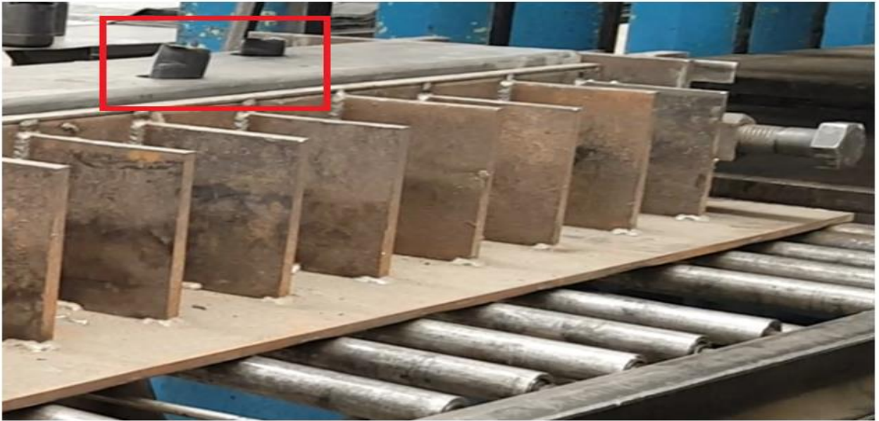
Figura 4.16: Inyección elastómero por perforaciones.
