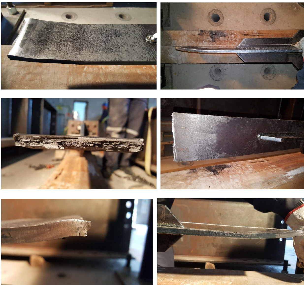
Figura 6.1: Fractura núcleo de acero prototipo A.
