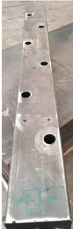
Figura 4.9: Perforaciones camisa exterior.
