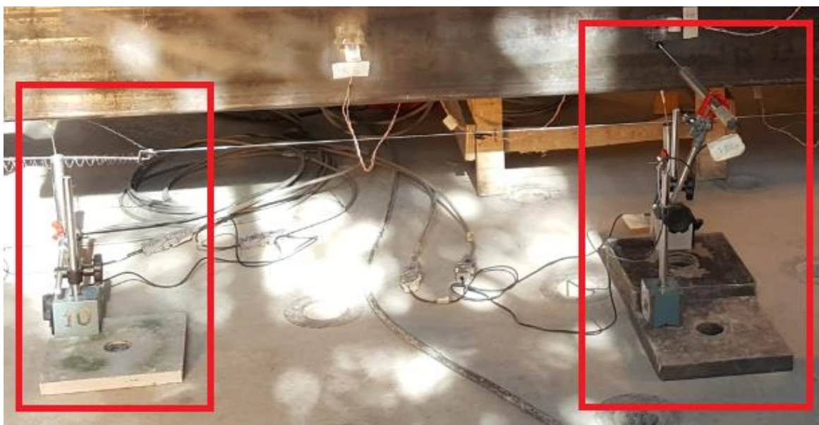
Figura 5.9: Incorporación sensor de desplazamiento fuera del plano.
