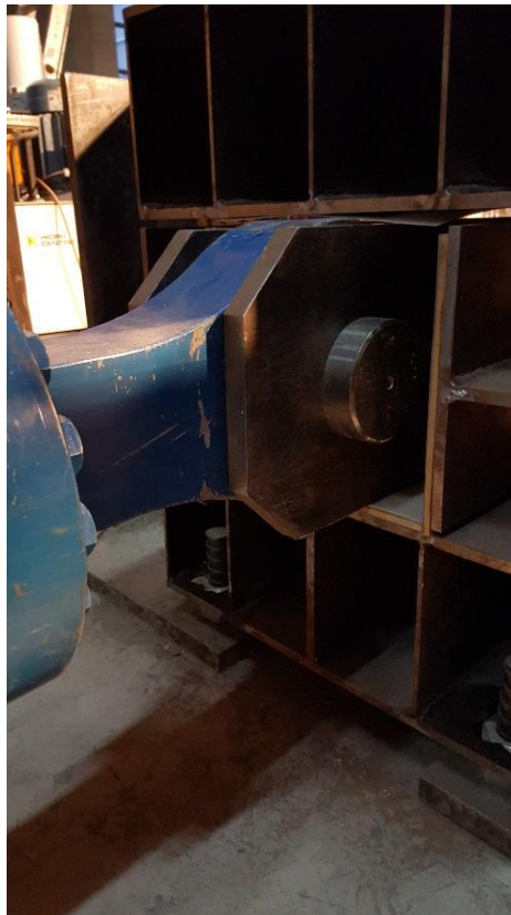
Figura 5.3: Unión actuador hidráulico y sistema móvil con pasador.
