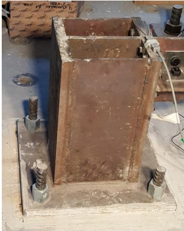
Figura 2.11: Apoyo fijo conectado al extremo del arriostramiento.
