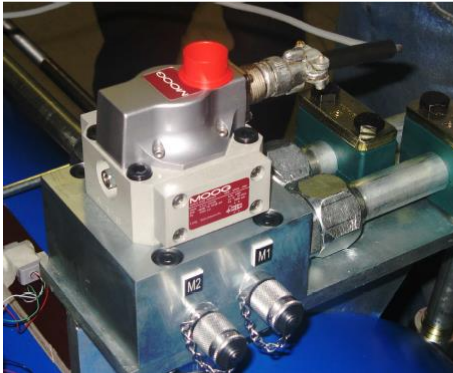
Figura 2.15: Servo válvula de control MOOG (Espinoza 2016).
