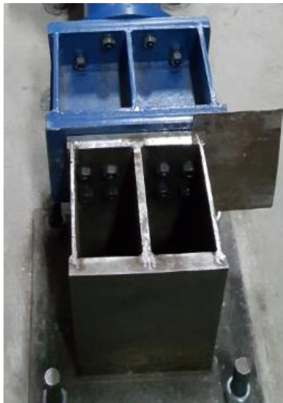
Figura 2.12: Apoyo fijo conectado al extremo del actuador.
