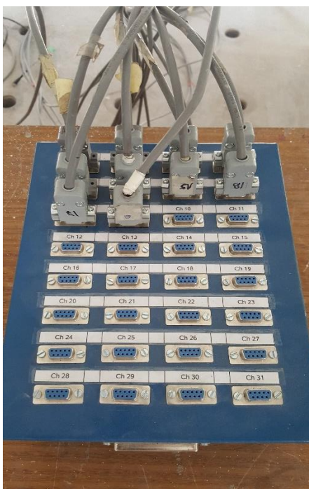
Figura 5.11: Conexión LVDTs al sistema de adquisición.
