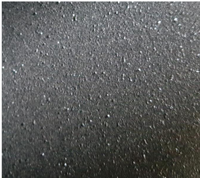
Figura 4.4: Superficie arenada – interfaz bondada.
