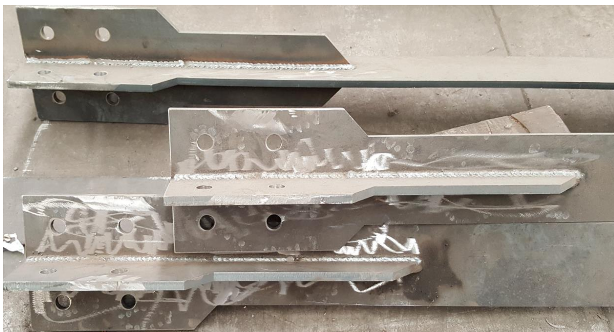
Figura 4.7: Perforado y soldadura núcleo de acero y atiesador.
