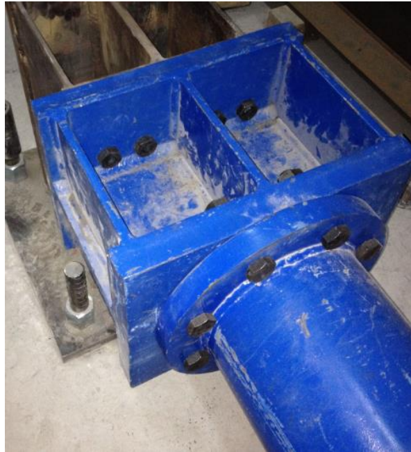
Figura 5.2: Unión apernada actuador hidráulico y apoyo fijo.
