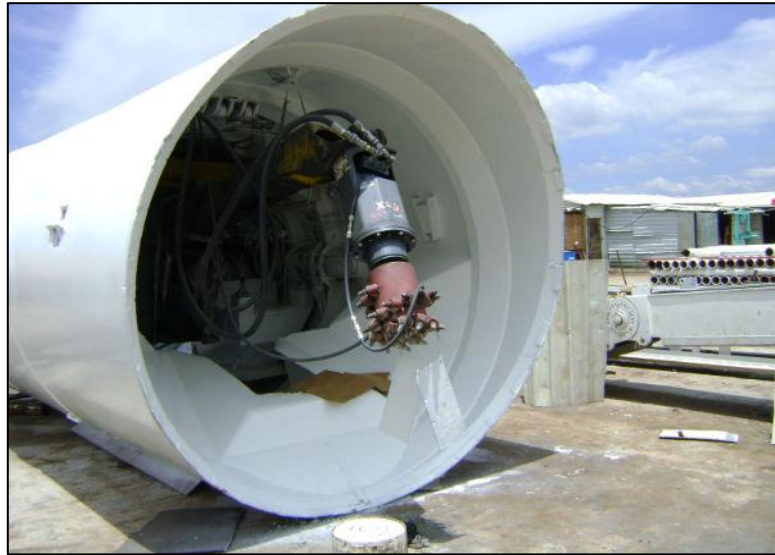
Figura 3.4 Escudo abierto con rozadora.
