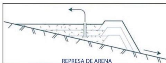
Figura A.10 Esquema de una represa de Arena. Fuente: UNESCO, (2005)
