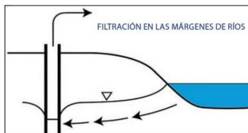
Figura A.19 Esquema de Bancos filtrantes en los lechos de un río. Fuente: UNESCO ,2005.
