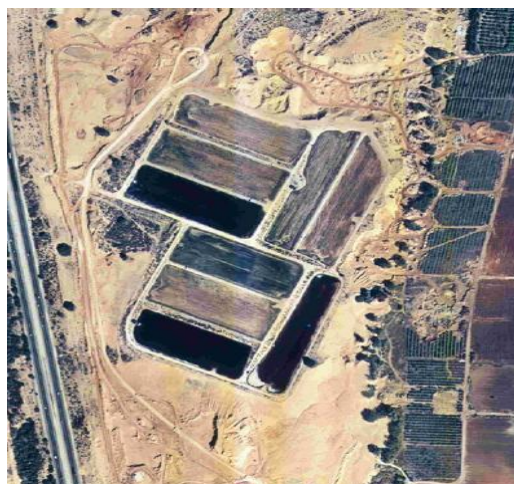
Figura A.2 Sistema de alternancia de ciclos llenado-secado y tratamiento de suelo (SAT) de las balsas de infiltración en Tel Aviv. Se observa la alternancia de balsas llenas y vacías para así, darle una mantención regular al sistema balsas de la Gestión de la Recarga de acuíferos. Fuente: LOFTUS ,2011.
