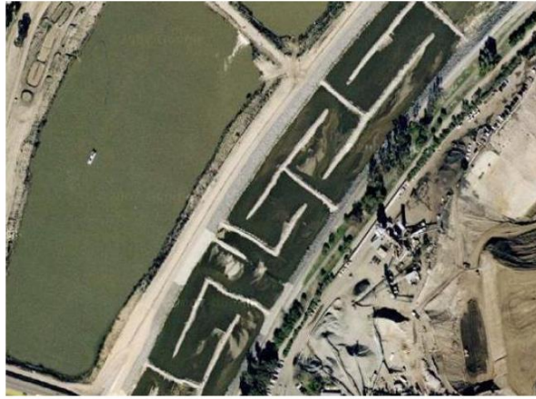
Figura A. 11 Imagen de satélite de los dispositivos de AR, mediante serpenteos en el río Santa Ana en Anaheim, California. Fuente: Fernández Escalante, 2010.
