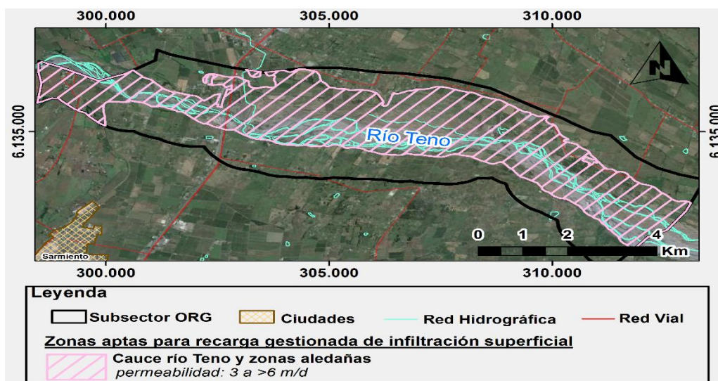
Figura 42. Zonas aptas para la instalación de mecanismos de infiltración superficial: Cauce del río Teno y sus depósitos fluviales actuales junto con las zonas aledañas al río Teno (rosado). Proyección UTM, DATUM WGS84, Huso 19 sur Fuente. Elaboración propia con datos de CIREN (2015).
