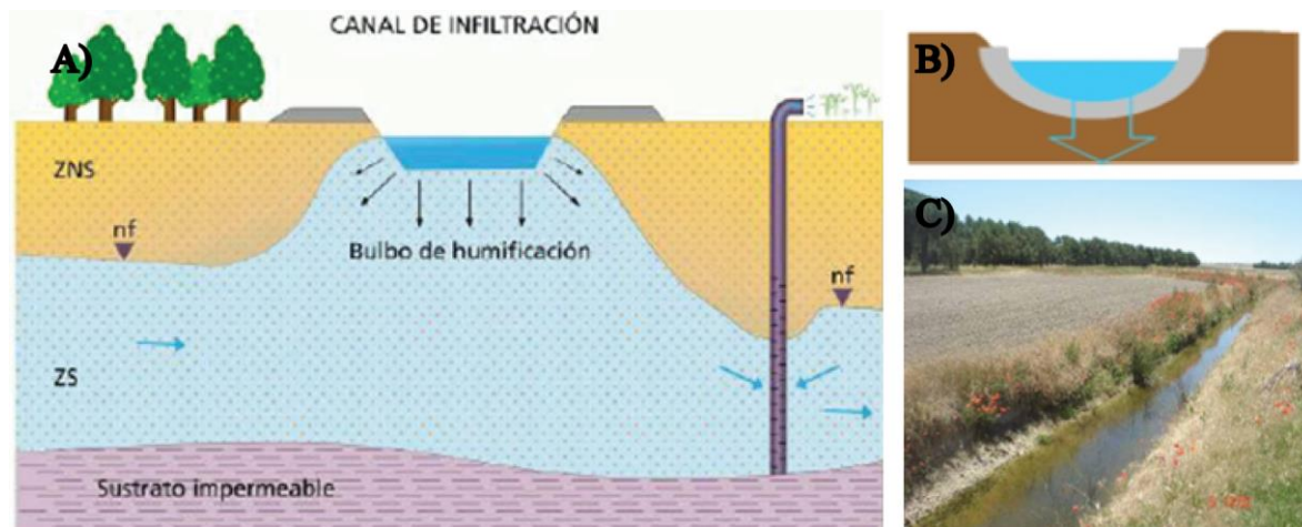
Figura A.3 Esquema de Canales de infiltración. A) y B) vista en perfil. C) Vista en diagonal. Fuente: Fernández Escalante, 2010.
