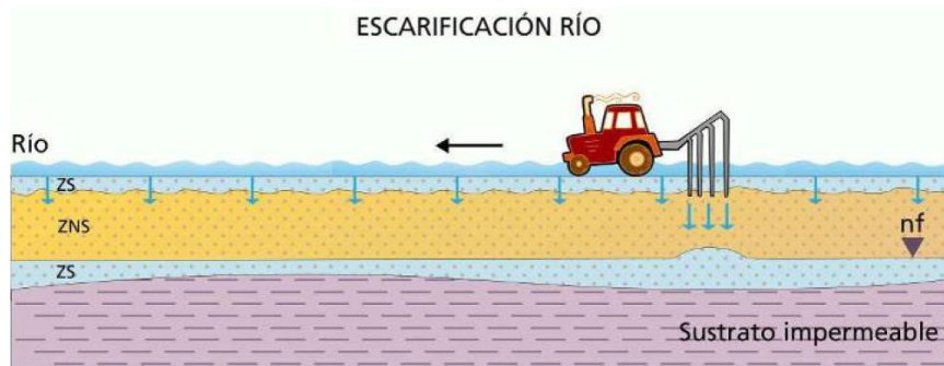
Figura A.12 Esquema de la escarificación de un río. Fuente: Fernández Escalante ,2010.
