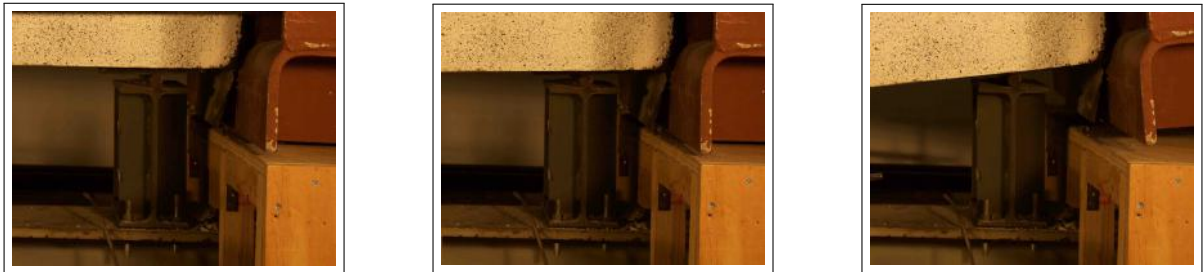
(a) Probeta inicialmente apoyada en el perfil (y éste sobre una mesa). (b) Probeta apoyada correctamente al agrietamiento. (c) Probeta apoyada correctamente al final del ensayo.
