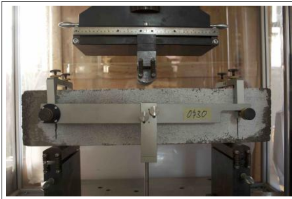
(a) Montaje experimental bajo normativa EN14651 midiendo desplazamiento vertical.
