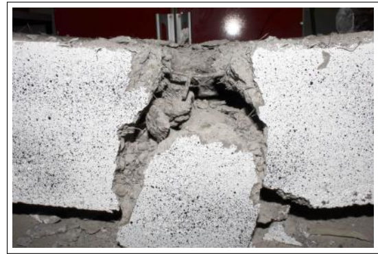
(b) Agrietamiento doble en las probetas DA1 y DA2.
