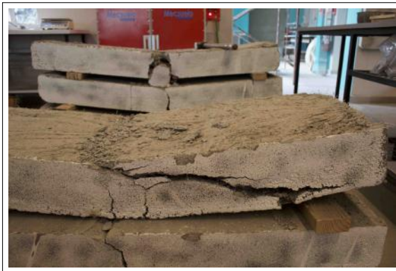
(c) Falla diagonal en la probeta DP1.
