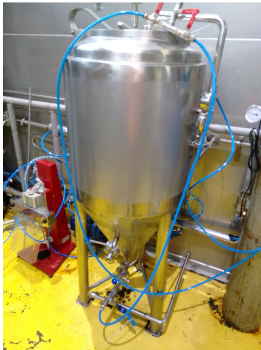
Figura 2.16: Gasificador de la planta piloto.
