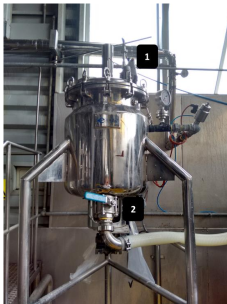
Figura 2: Macerador de la planta piloto de cervezas y extractos. Ubicación de las válvulas 1 y 2.
