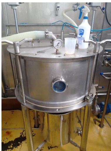
Figura 6: Filtro vertical de la planta piloto.
