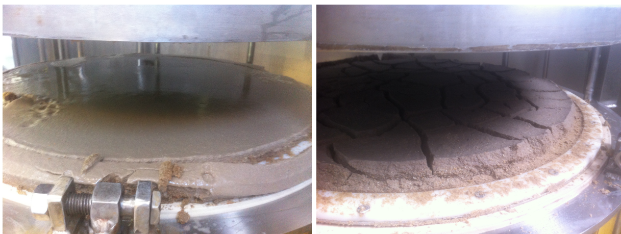
Figura 4.3: Fotografías a la torta dormada durante la filtración de dos batches del lote de prueba. A la izquierda, una fotografía de la torta del batch P1, que utilizó malta Pilsen Patagonia Malt . A la derecha, una fotografía de la torta del batch P2, que utilizó malta Pilsen Castle Malting .
