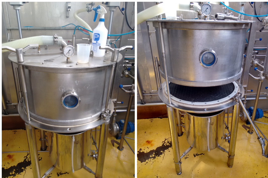
Figura 2.12: Filtro vertical de la planta piloto. A la izquierda, el filtro listo para ser utilizado. A la derecha, alzamiento de la carcasa superior para la remoción de la malla del filtro.
