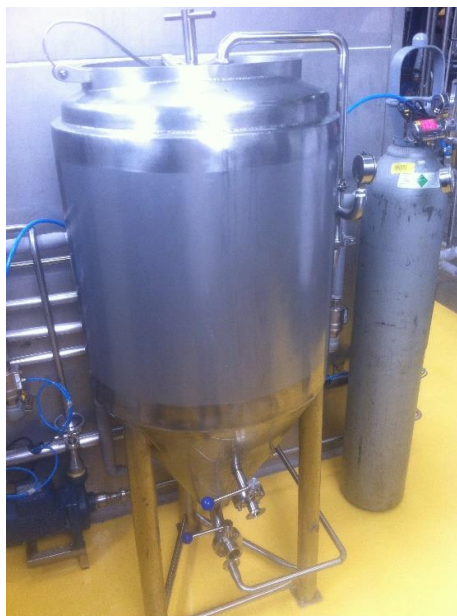
Figura 14: Gasificador de la planta piloto. Al inferior, la válvula 51.
