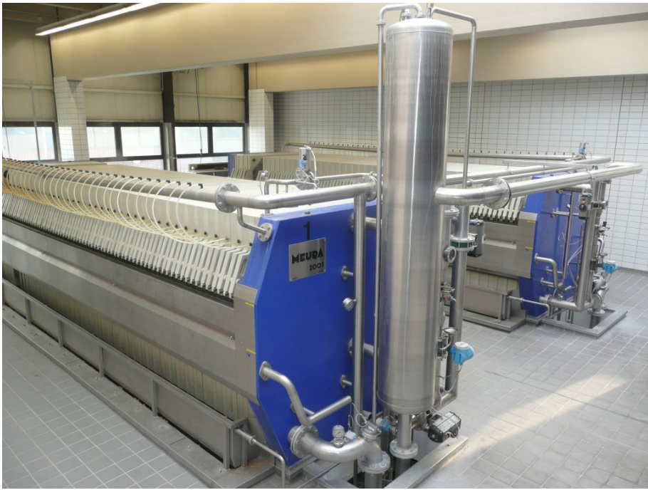
Figura C.4: Fotografía a un filtro de membrana compresora. Fuente: Wallart Equipments, 2016 [48].
