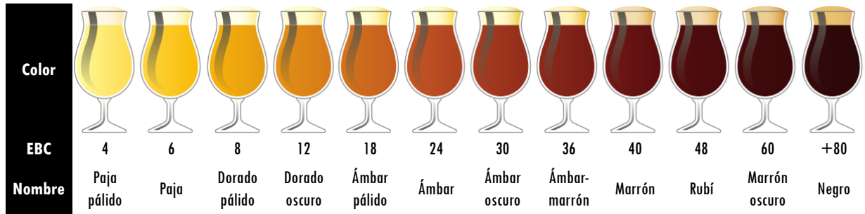
Figura 2.1: Escala de colores EBC. Los nombres presentados para cada ejemplo no son oficiales, por lo que deben tomarse sólo como una referencia. Adaptado de Mosher, 2015 [13].
