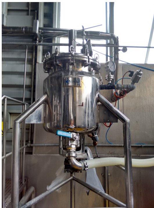
Figura 2.11: Macerador de la planta piloto.
