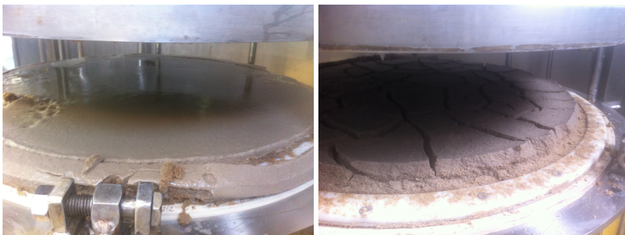
Figura H.1: Fotografías a la torta dormada durante la filtración de dos batches del lote de prueba. A la izquierda, una fotografía de la torta del batch P1, que utilizó malta Pilsen Patagonia Malt. A la derecha, una fotografía de la torta del batch P2, que utilizó malta Pilsen Castle Malting.
