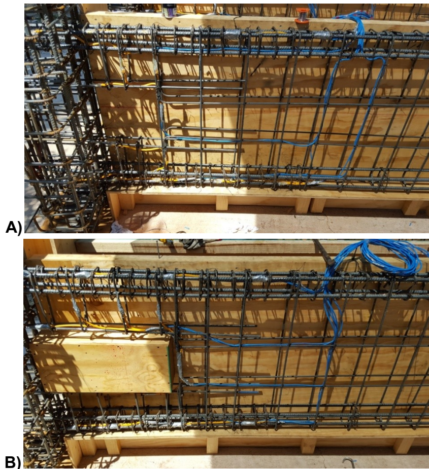
Figura 3.18: Cableado probetas: A) probeta MR2. B) Probeta MR3.
