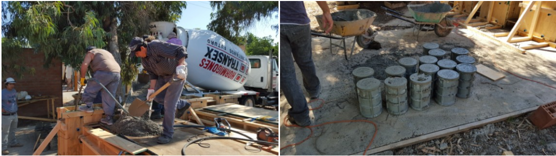
Figura 0.12: Hormigonado probetas y cilindros para ensayos de compresión.
