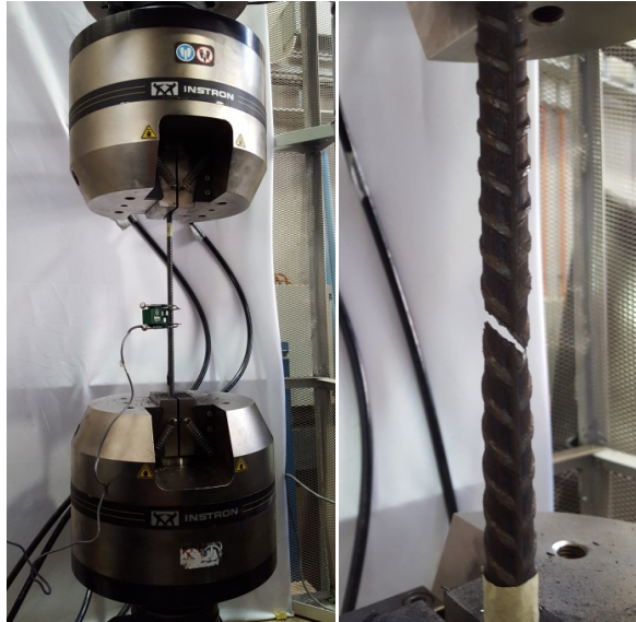
3.6: Montaje ensayo de tracción.
