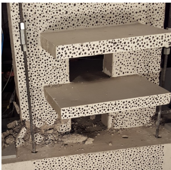
Figura 0.36: Falla localizada bajo la losa inferior MR4 al final del ensayo.
