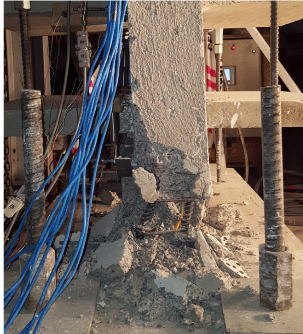
Figura 0.34: Pandeo fuera del plano después del ensayoMR4.
