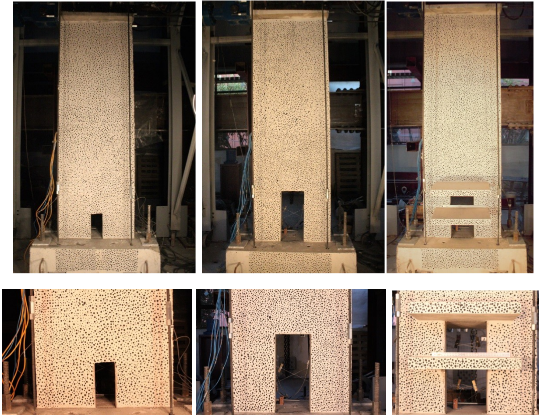
Figura 3.22: Pintado de muros para fotogrametría MR1, MR3 y MR4.
