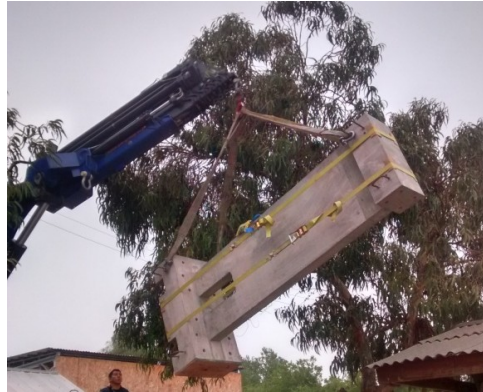
Figura 3.9: Transporte con eslingas de seguridad para probeta en compresión.
