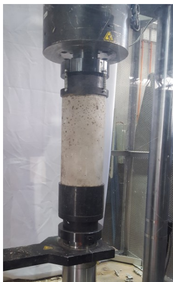
Figura 3.5: Montaje ensayo de compresión cilindros
