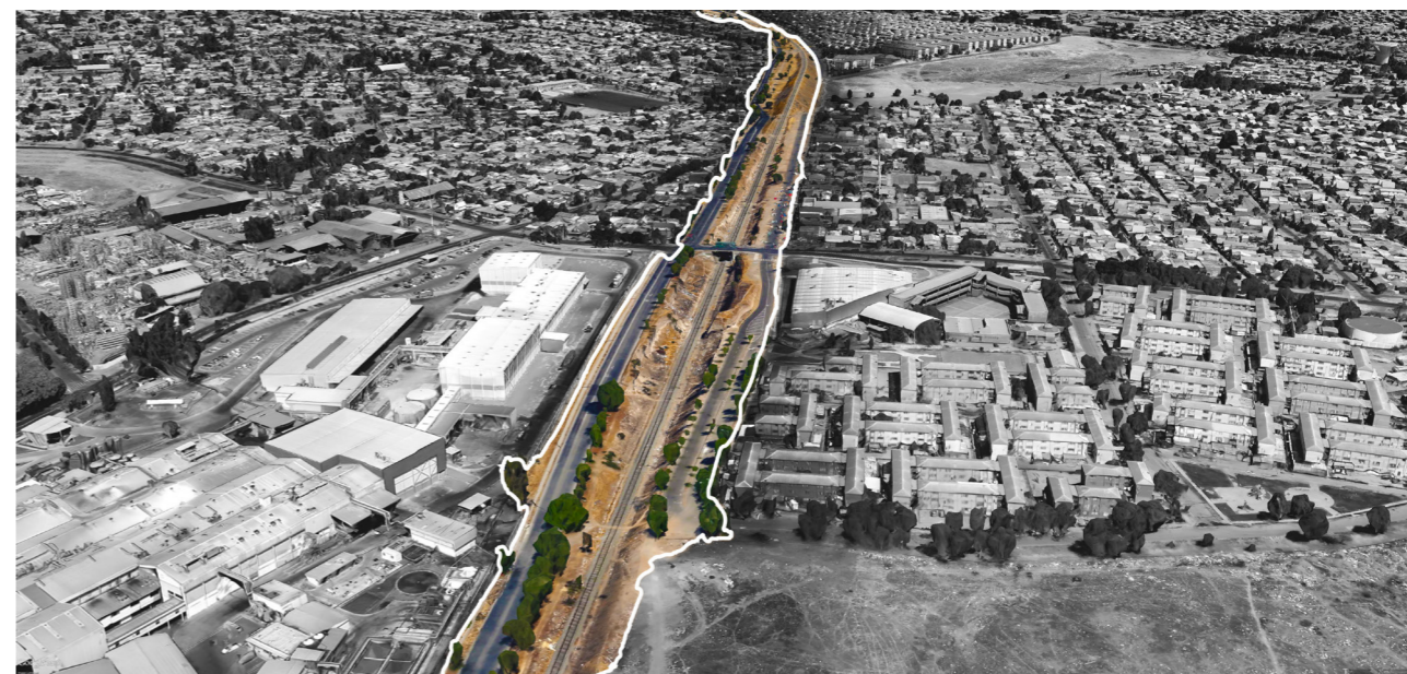
Figura 19: Franja de 20 metros de ancho para resguardo de infraestructura ferroviaria según art. 34 del DFL 1157, denominada la Ley de Ferrocarriles, y el art.8.4.1.1 del PRMS. Vista hacia el poniente del cruce Lo Errazuriz con línea de Ferrocarril.
