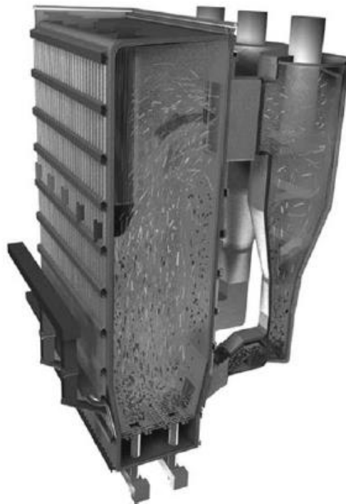
Figura 17: LFC para incineración de RSM. Fuente: [3131].
