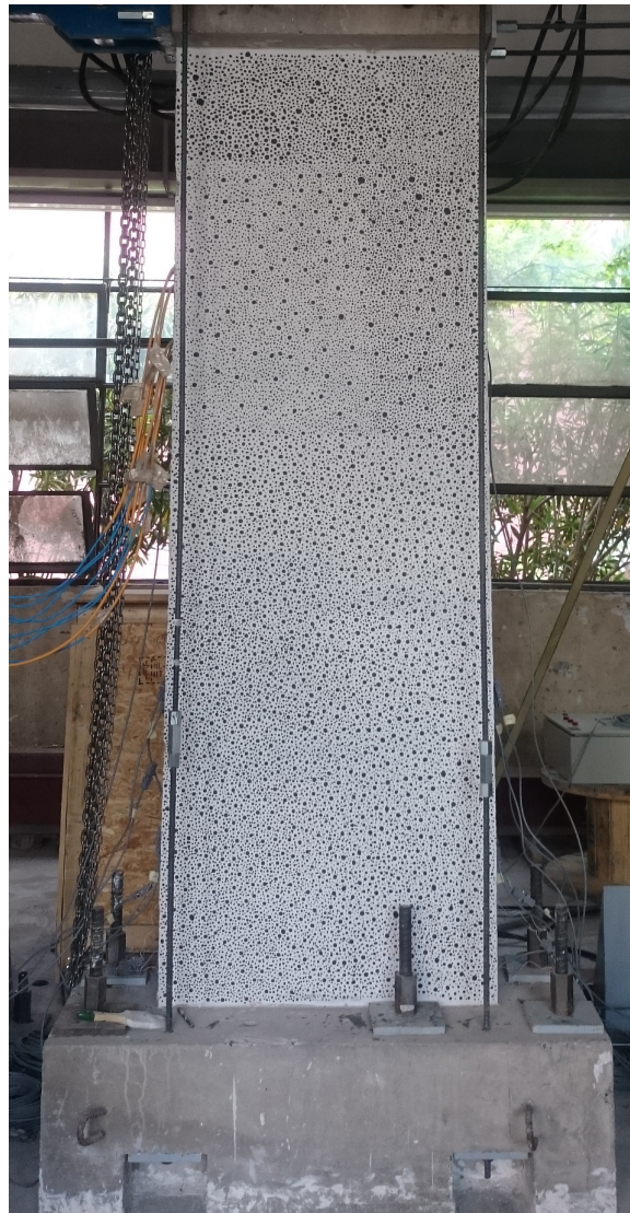
Figura 3.5.21: Patrón de manchas generado para Ensayo 1.
