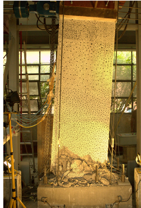
(b) Muro 1 al final del ensayo.
