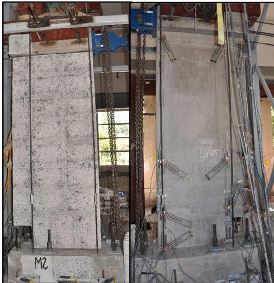
Figura 39: Ambas caras de la probeta 2. a) Montaje de Fotogrametría; b) Montaje de LVDTs
