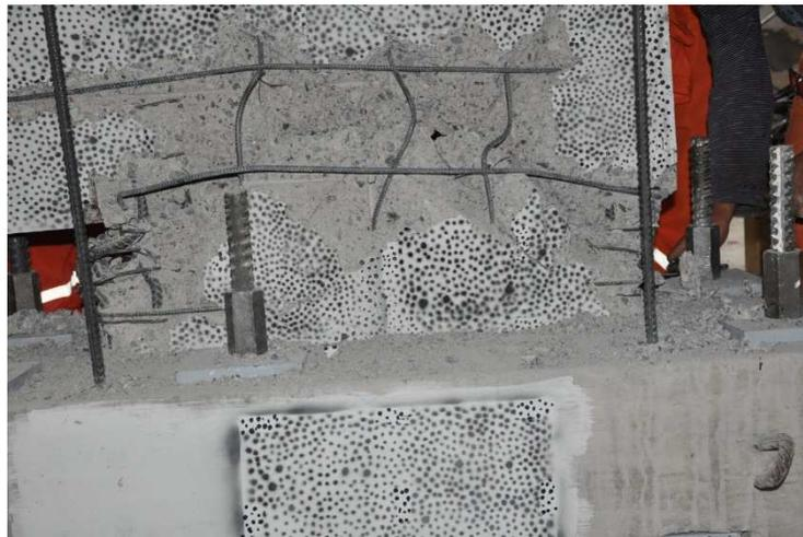
Figura 77: Pandeo de armadura de borde y armadura distribuida vertical
