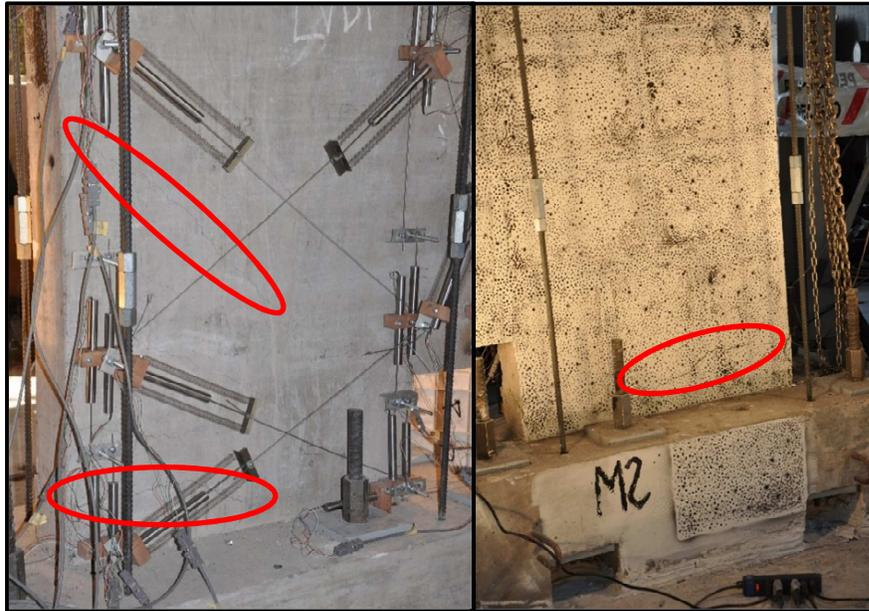
Figura 67: Agrietamiento de Probeta 2 ante un desplazamiento en sentido positivo
