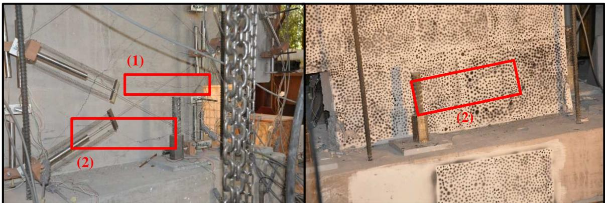
Figura 73: Grietas horizontales ante un desplazamiento en sentido negativo
