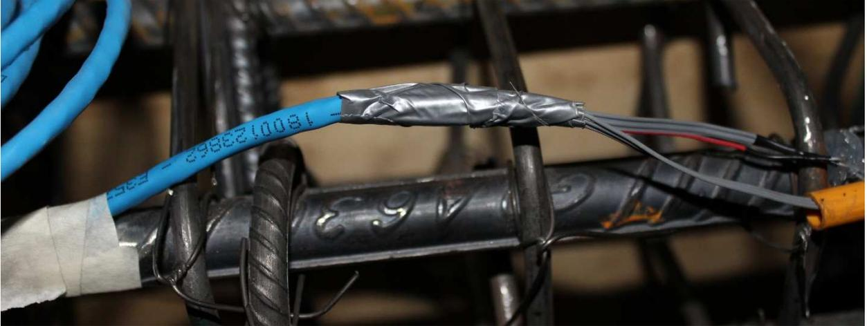
Figura 29: Conexión de Strain Gages con cable de extensión
