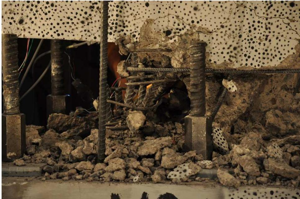
Figura 71: Barras de refuerzo longitudinal cortadas por fatiga del material
