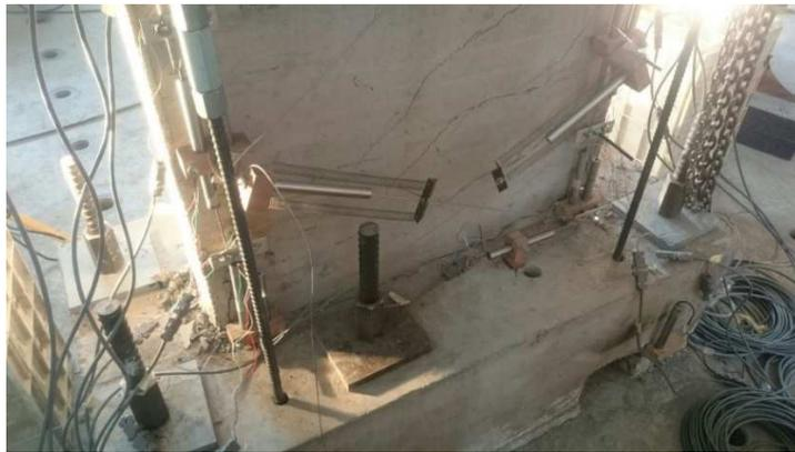
Figura 62: Ensayo de Probeta 1 ante un 3% de deriva de techo en sentido positivo
