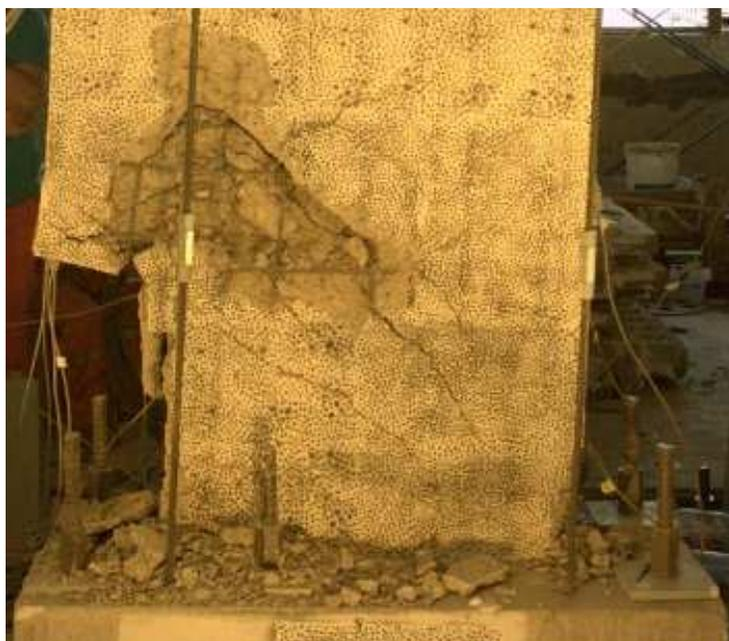
Figura 123: Zona de falla de la probeta 4.
