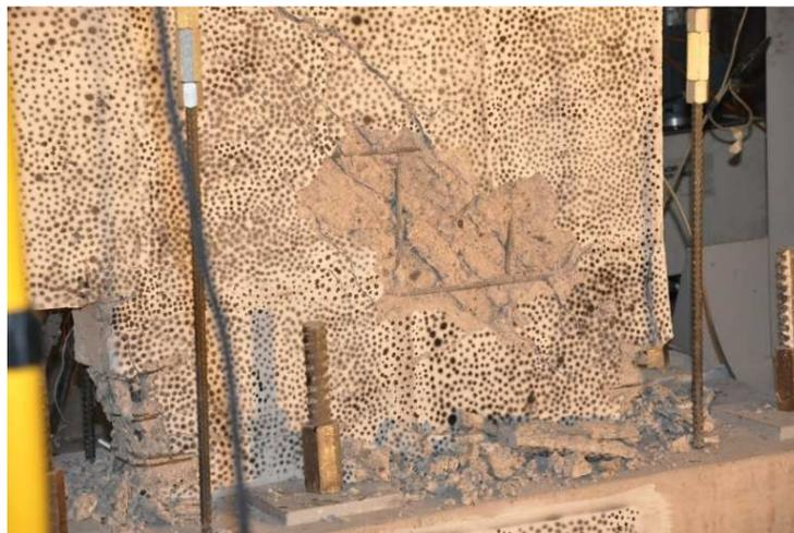
Figura 75: Pérdida de hormigón en la cara principal. 4% de la deriva en sentido negativo
