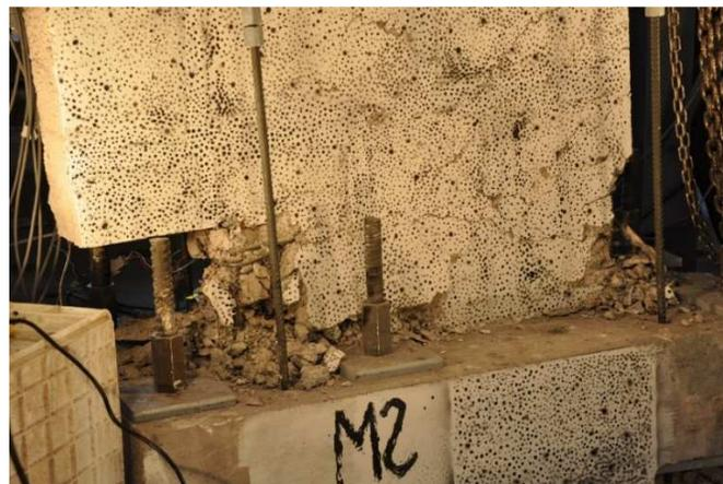
Figura 68: Primer ciclo del 4% de la deriva en Probeta 2
