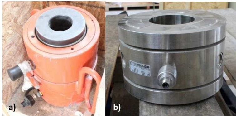
Figura 21: a) Gato hidráulico; b) Celda de carga
