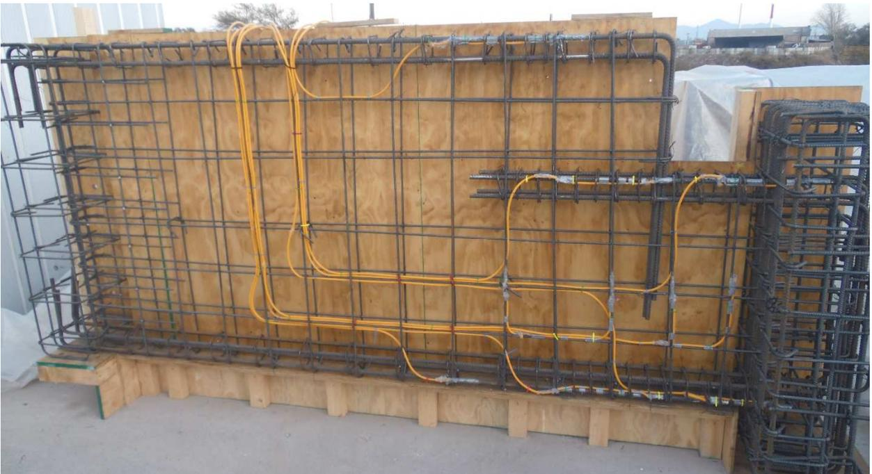
Figura 30: Red de cables de extensión dentro de probeta 3
