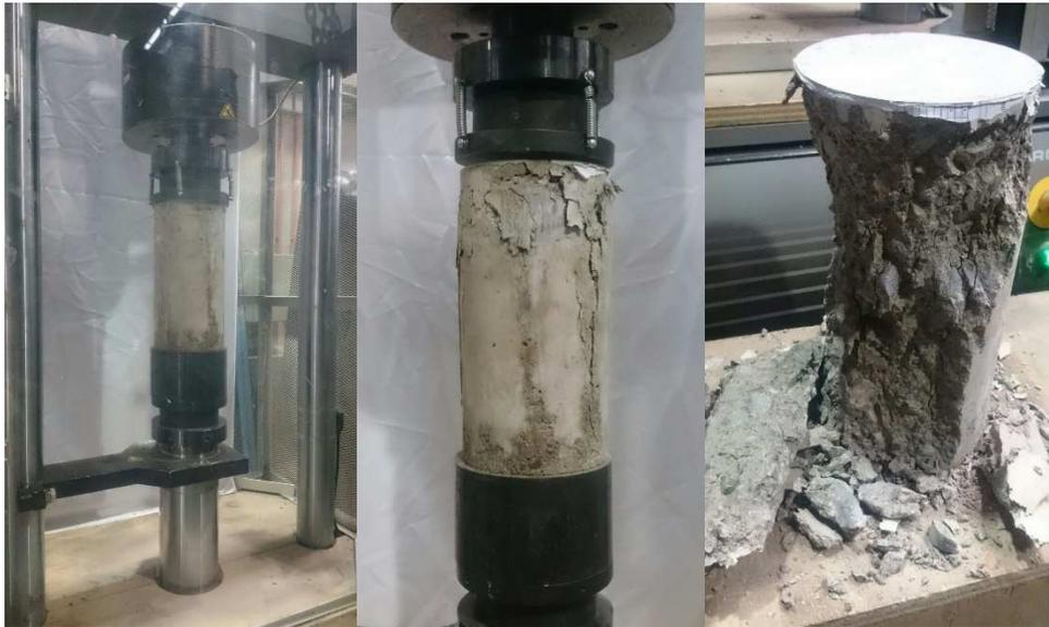
Figura 34: Ensayo a compresión de cilindros de hormigón
