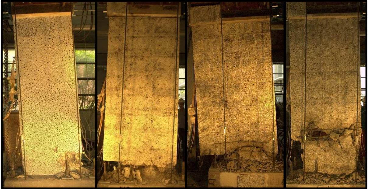
Figura 84: Forma de falla para cada probeta: (a) Muro 1; (b) Muro 2; (c) Muro 3; (d) Muro 4
