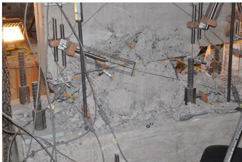
Figura 70: Desprendimiento del hormigón en la cara donde se instalaron los LVDTs
