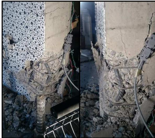
Figura 64: Imágenes del 4% de la deriva para probeta 1
