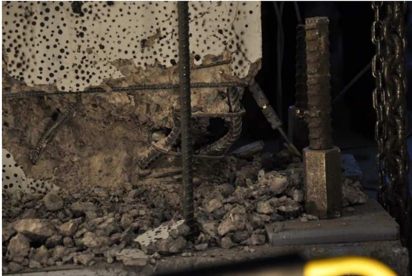
Figura 69: Pandeo de refuerzo longitudinal
