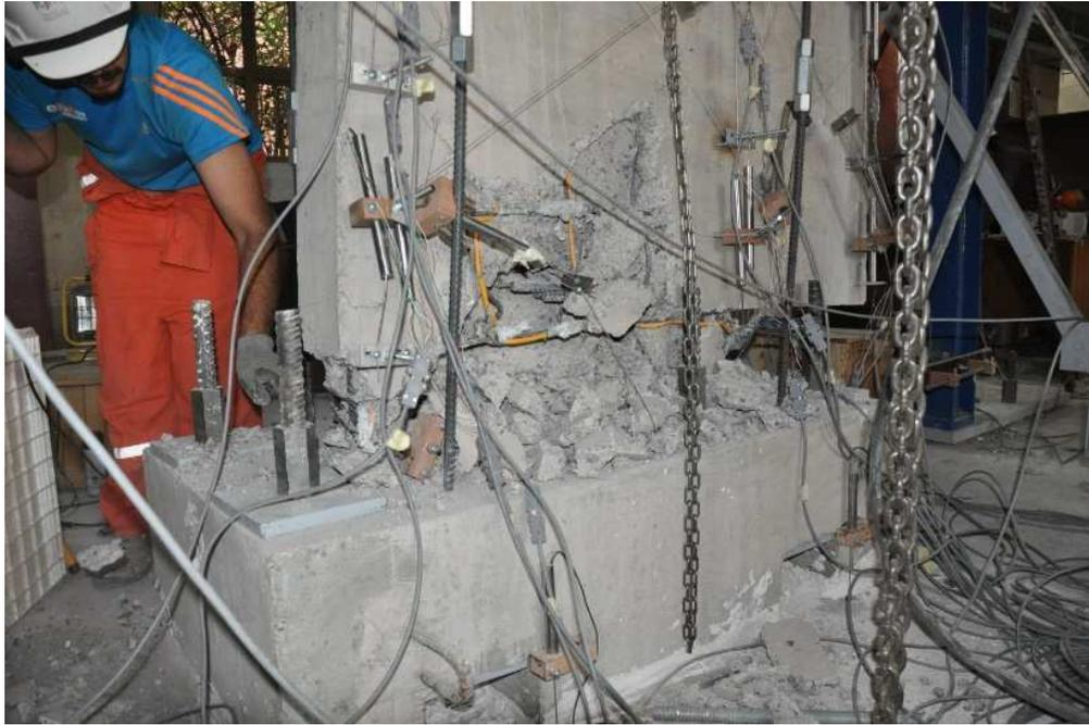
Figura 78: Falla del muro a la altura de la abertura
