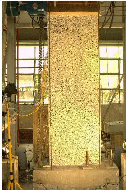
Figura 43: Manchado de puntos para fotogrametría Probeta 1
