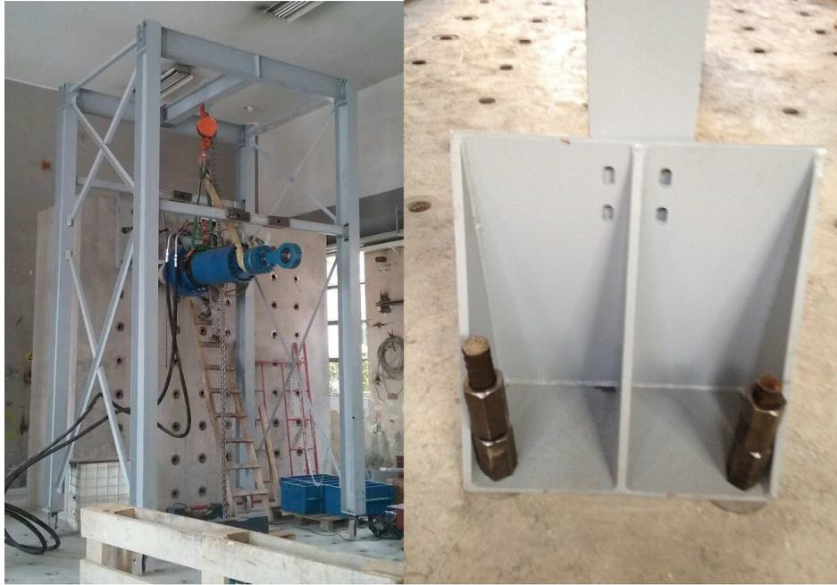
Figura 19: Marco de Acero y conexión con la losa
