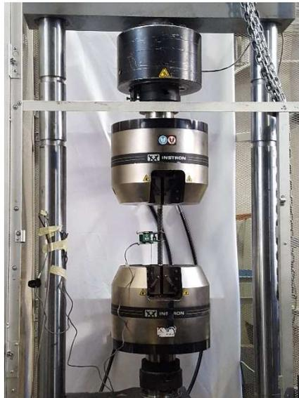
Figura 35: Ensayo de barra a tracción
