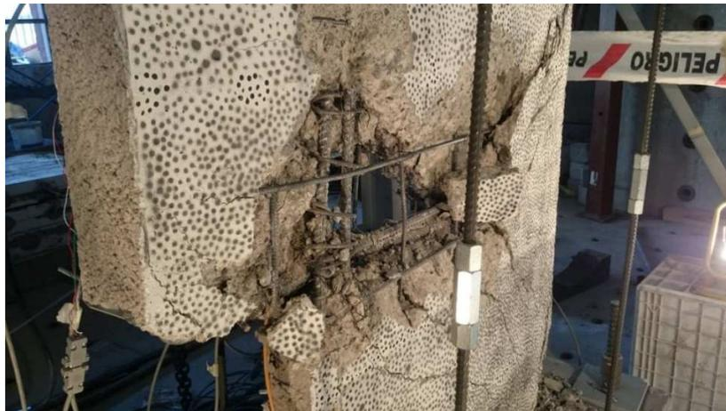
Figura 80: Imagen del 4% de la deriva de probeta 4
