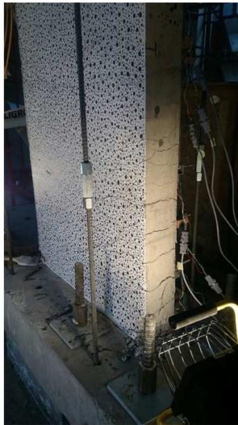
Figura 63: Primero ciclo del 4% de la deriva en sentido negativo de Probeta 1. Grietas atraviesan el ancho del muro
