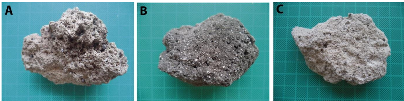
Figura 12: Tipos de escorias presentes en el depósito. A: Escoria Parda. B: Escoria Gris Densa. C: Escoria Blanquecina.
