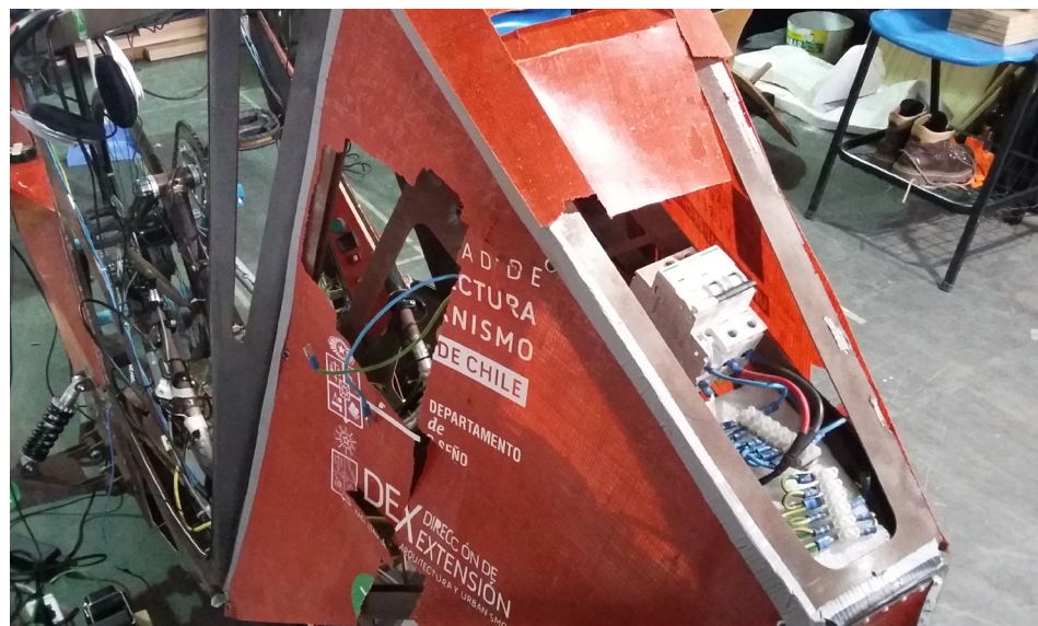
Rotura del panel trasero izquierdo debido a la caída de una batería. Fuente: Fotografías del autor
