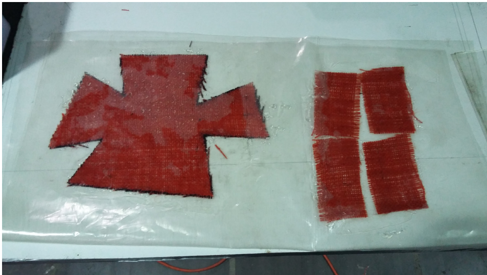
Preimpregnado de la tela a laminar. Fuente: Fotografías del autor
