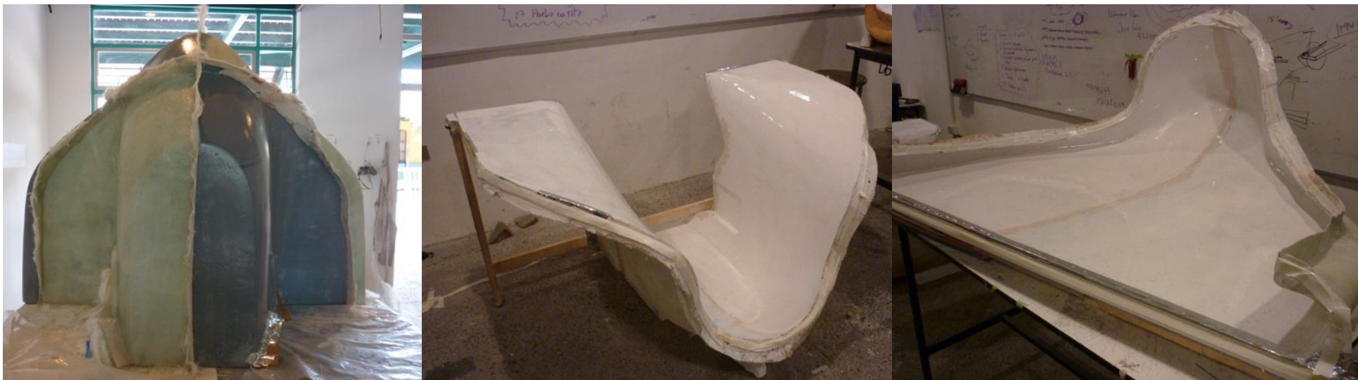
Fabricación de los moldes del Protean 1. Fuente: Campos, 2013
