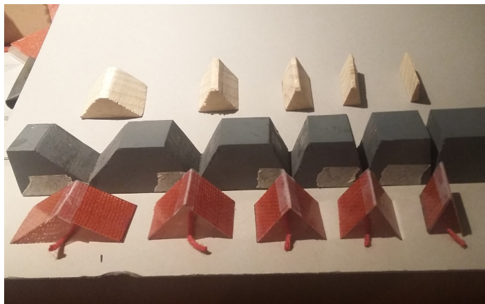
Matriz de ángulos para refuerzo de arista de pliegue. Fuente: Fotografía del autor
