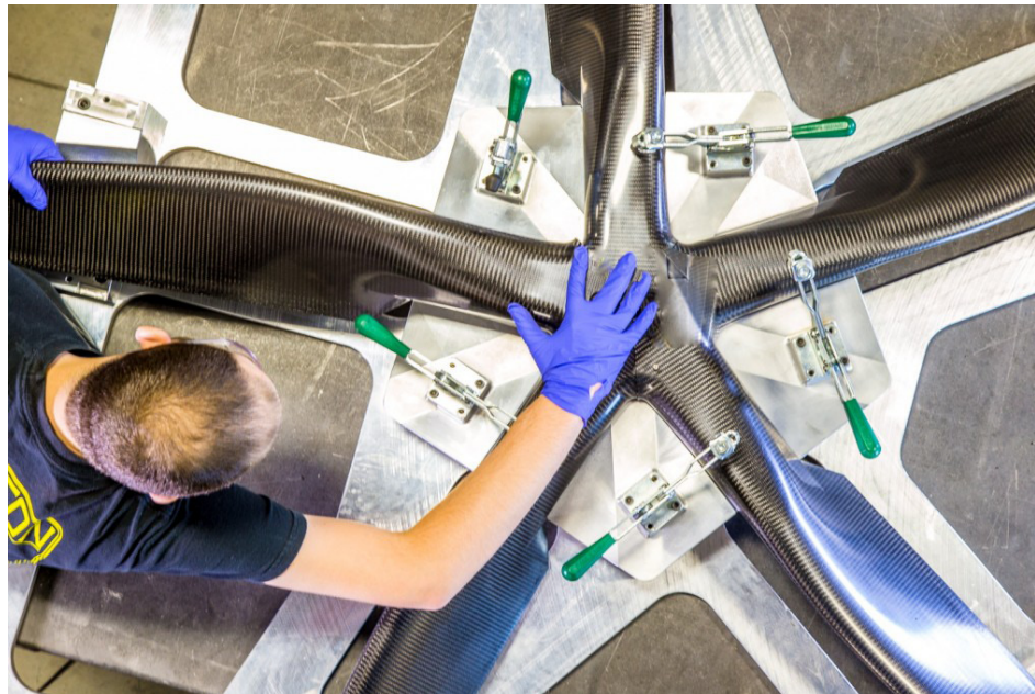
Fabricación de una hélice en materiales compuestos. Fuente: www.innovativecomposite.com
