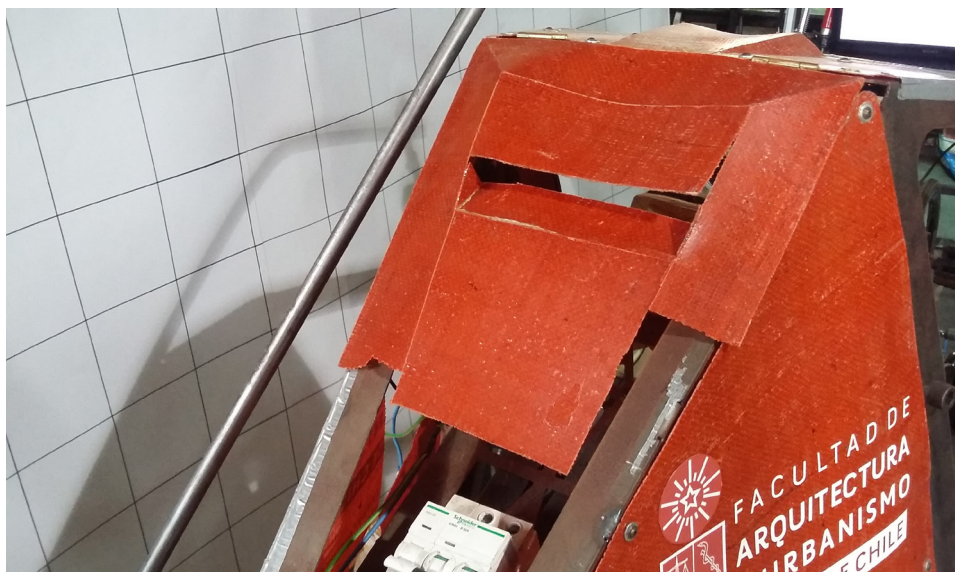
Rotura de la compuerta trasera debido a una ráfaga de viento. Fuente: Fotografías del autor
