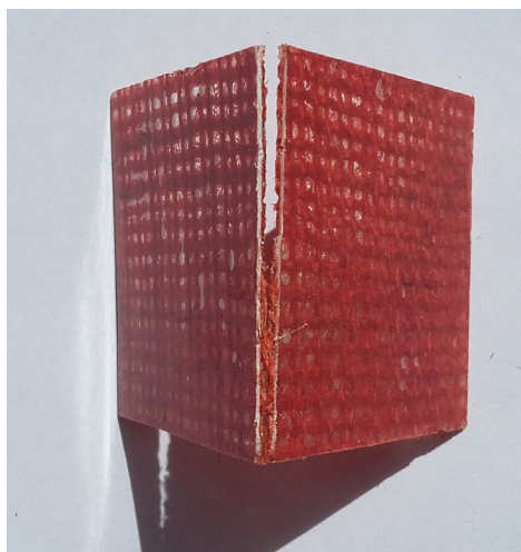
Rotura en plegado en compuesto de 1 capa. Fuente: Fotografía del autor
