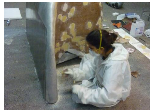
Arreglo de superficie del carenado del Protean 1. Fuente: Campos, 2013
