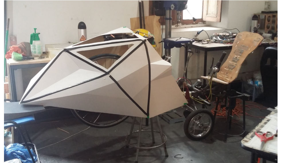
Modelo 1:1 del carenado en cartón forrado sobre el chasis de pruebas del Protean Ackiu. Fuente: Fotografías del autor
