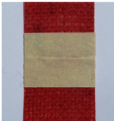
Refuerzo en arista de pliegue en compuesto de 1 capa. Fuente: Fotografía del autor
