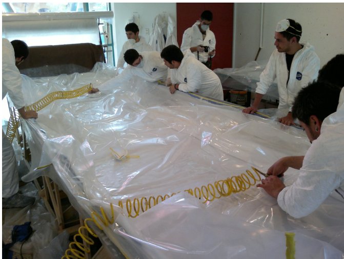
Laminado al vacío del carenado del Eolian 3. Fuente: Fotografía del autor
