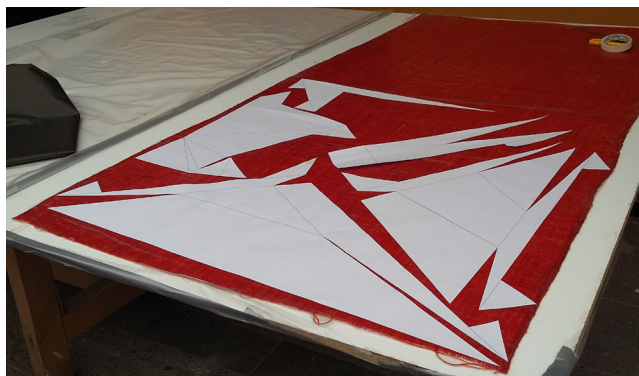
Corte del formató laminar de composto utilizando plantillas de corte. Fuente: Fotografías del autor
