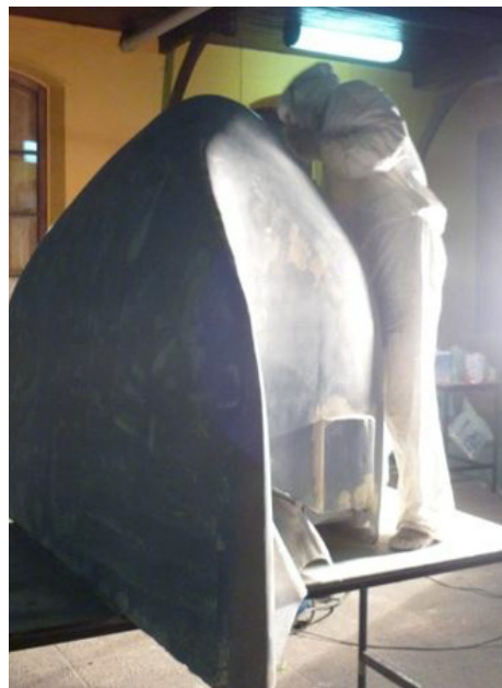
Fabricación del master del Protean 1. Fuente: Campos, 2013
