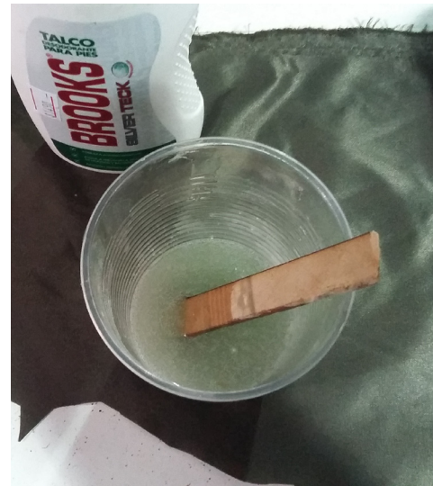
Talco como carga para el refuerzo de los cantos internos. Fuente: Fotografías del autor
