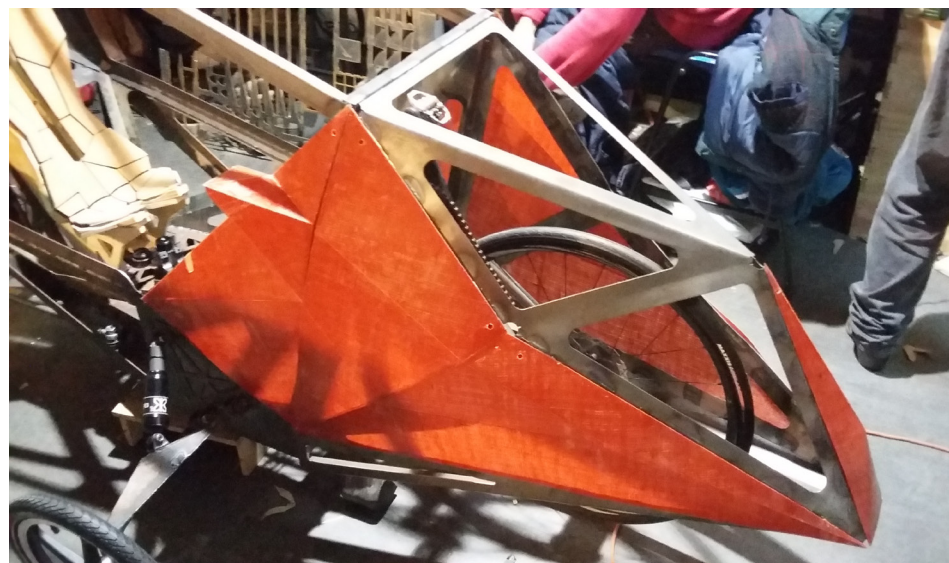
Ensamble del carenado. Fuente: Fotografías del autor
