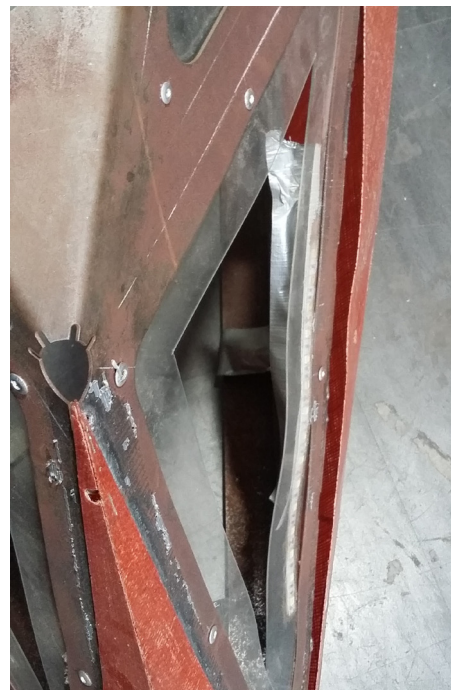
Deformación del carenado por humedad y temperatura. Fuente: Fotografías del autor
