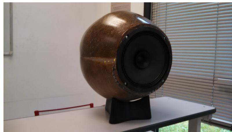
Carcasa de parlante de compuesto de yute Fuente: jute-lab.org
