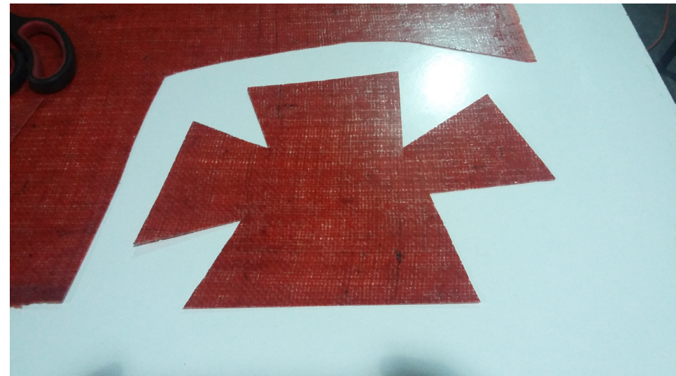
Geometría desarrollada de la probeta. Corte de compuesto de 1 capa Fuente: Fotografía del autor
