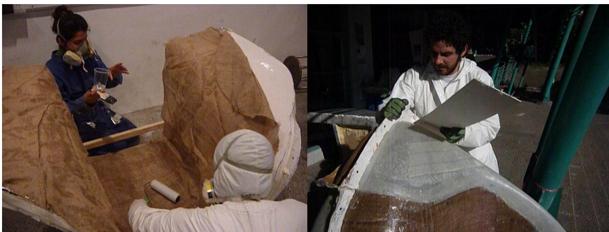
Laminado del carenado del Protean 1. Fuente: Campos, 2013
