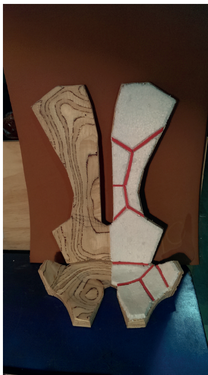
Imagen 46: Plantillas y prototipos enfocados de poliestireno expandido: aplicación al modelo digital y corte en fresadora CNC. Fuente: Elaboración propia.
