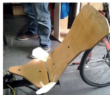
Imagen 20: Proceso de elaboración de los sopotes laterales, de cartón a madera. Fuente: Elaboración propia.
