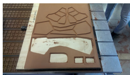
Imagen 46: Plantillas y prototipos enfocados de poliestireno expandido: aplicación al modelo digital y corte en fresadora CNC. Fuente: Elaboración propia.
