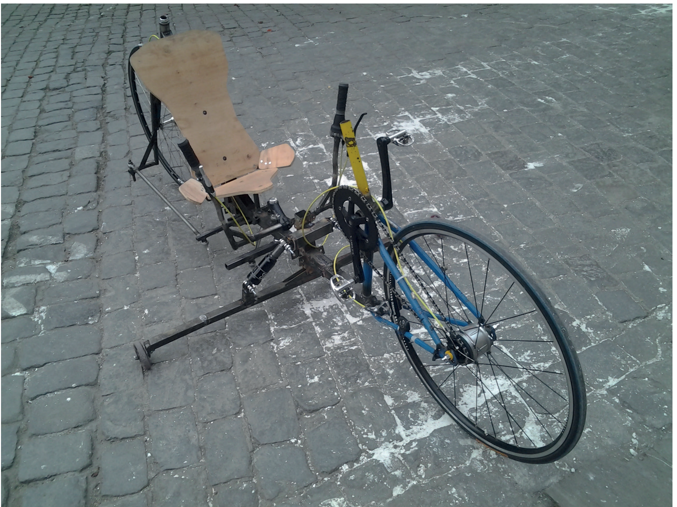
Imagen 17: Prototipo Alfa con asiento plano. Fuente: Elaboración propia.
