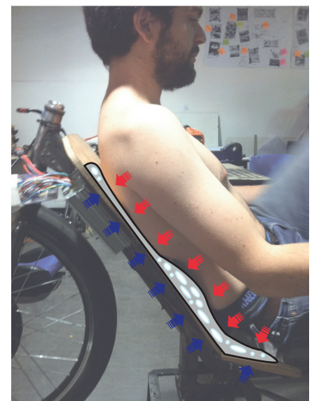
Imagen 25: Comportamiento de la espuma presionada por el cuerpo. Fuente: Elaboración propia.
