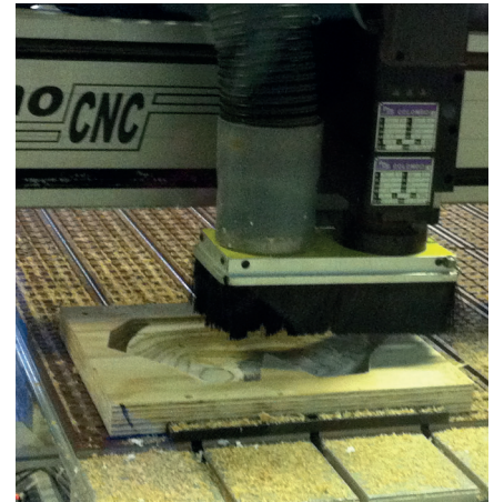
Imagen 30: Tallado en fresadora CNC. Fuente: Elaboración propia.
