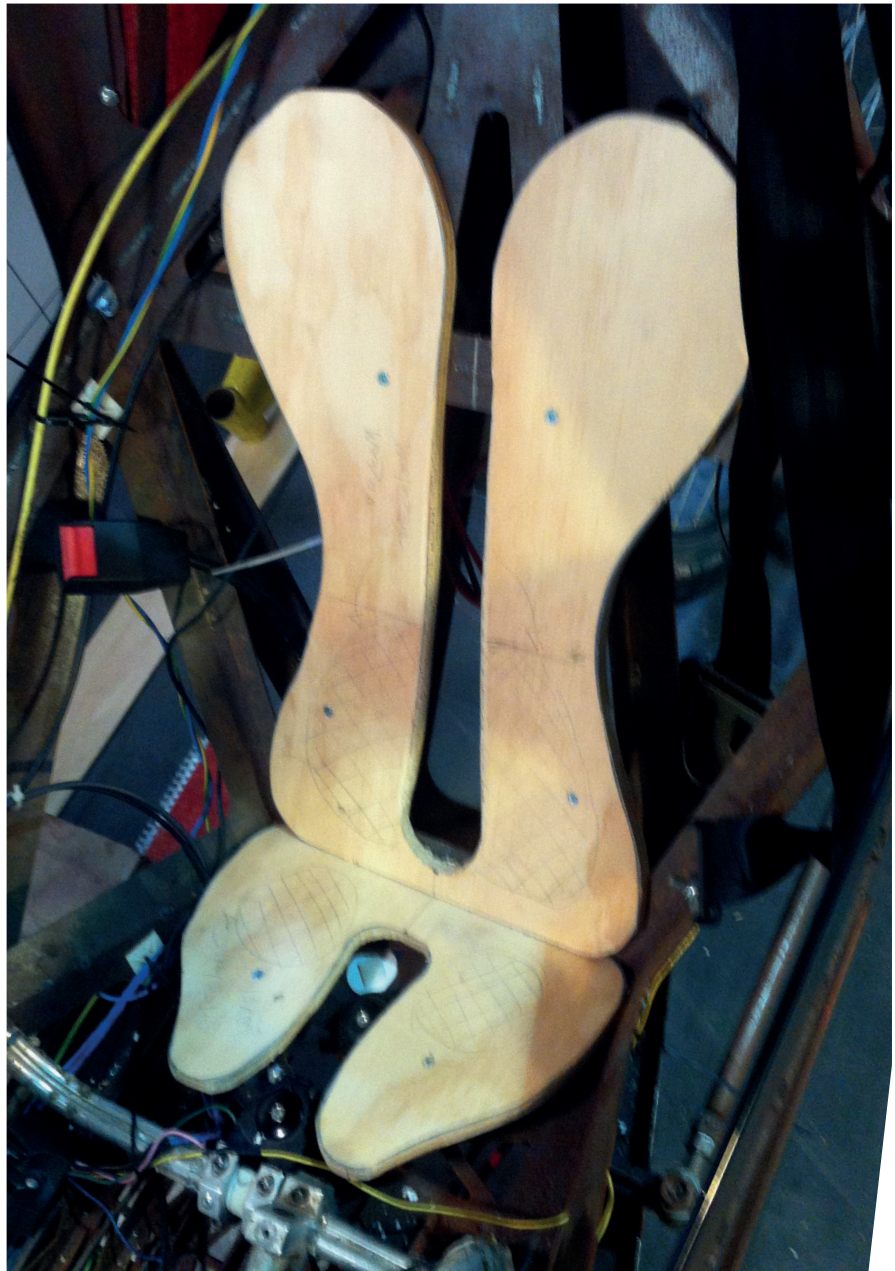
Imagen 21: Asiento plano con la mínima superficie de apoyo. Fuente: Elaboración propia.
