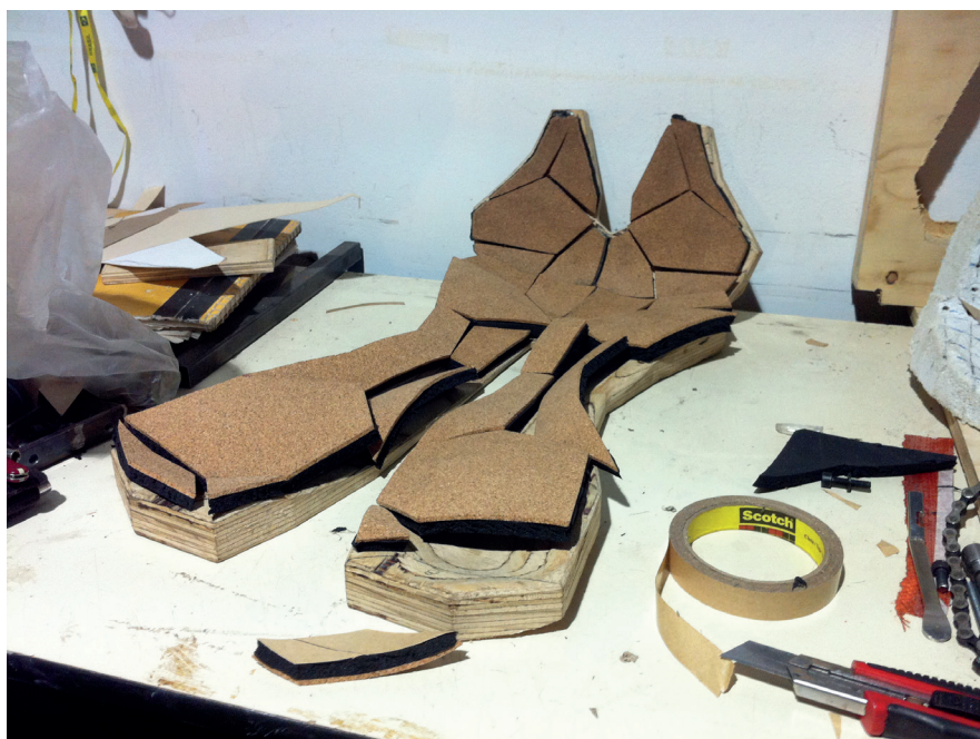
Imagen 32: Acolchado y detalles finales del prototipo. Fuente: Elaboración propia.
