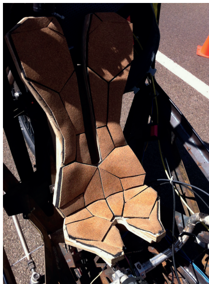
Imagen 38: Desgaste en los bordes del asiento; pérdida de las propiedades de la espuma. Fuente: Elaboración propia.
