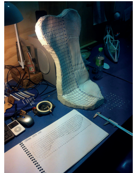
Imagen 28: Medición de las curvas del molde. Fuente: Elaboración propia.
