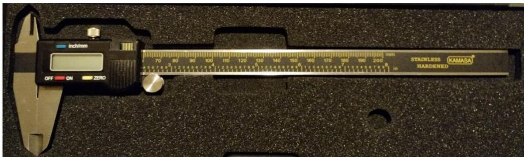
**Figura 13:** Calibrador digital KM-448, marca Kamasa®.
