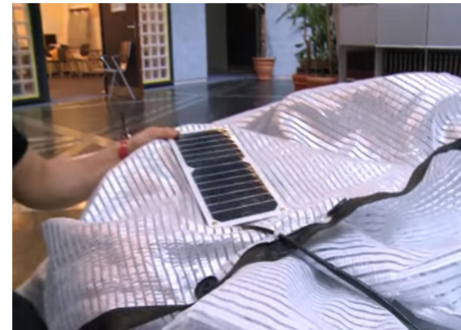
Imagen 27: Panel solar al interior de tela techumbre. Fuente: http://www.plataformaarquitectura.cl/
