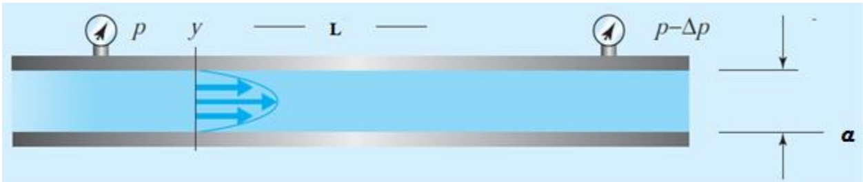
Figura 3.15 Flujo a través de placas paralelas. Fuente [9]
