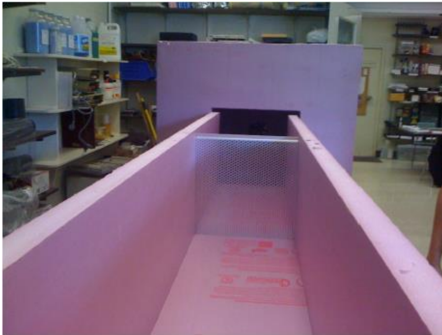
Figura 3.17 Instalación de un túnel de viento con una placa perforada en su centro. Fuente [11]
