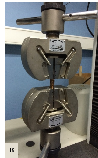
Figura 24: A. Muestras previo a las pruebas (cortadas con láser). Elaboración propia; B. Equipamiento para ensayos de tracción y compresión. Elaboración propia.
