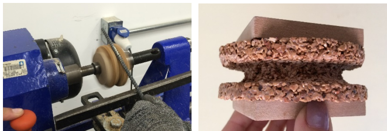
Figura 22:A. Torneado con escofina ; B. Resultado en probeta.
