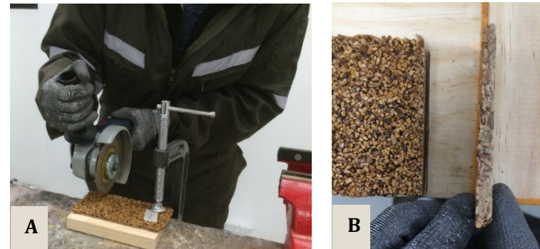
Figura 17: A. Corte con esmeril; B. Esmeril
