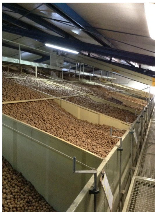
Fotografías del proceso de producción: Selección, secado y paso a homogeneizadores de humedad.
