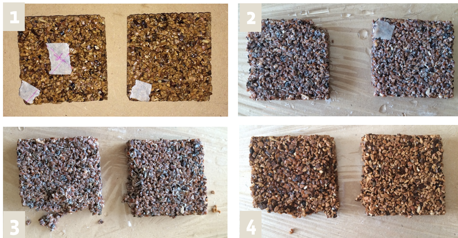
Figura 39: Probetas familia 2 (70-30%) a lo largo del tiempo en ensayo de absorción de humedad.
