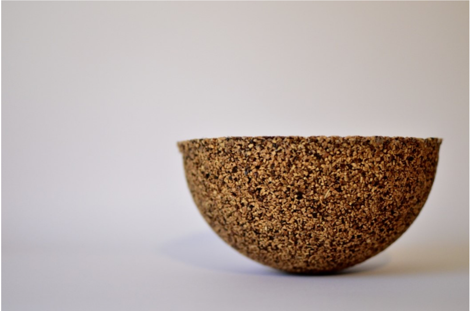
Figura 50: Prototipo molde 2, 1cm de espesor
