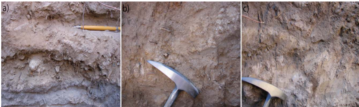
Figura 59: Muestras Morrena 2 [M2] a) Depósito lenticular de limo masivo [M2-C14-40]; b) Depósito limo [M2-C14-85]; c) Depósito limo masivo con alternancia de depósitos de distinta granulometría desde gravilla a grava con matriz de arena media a gruesa [M2-C14-165].
