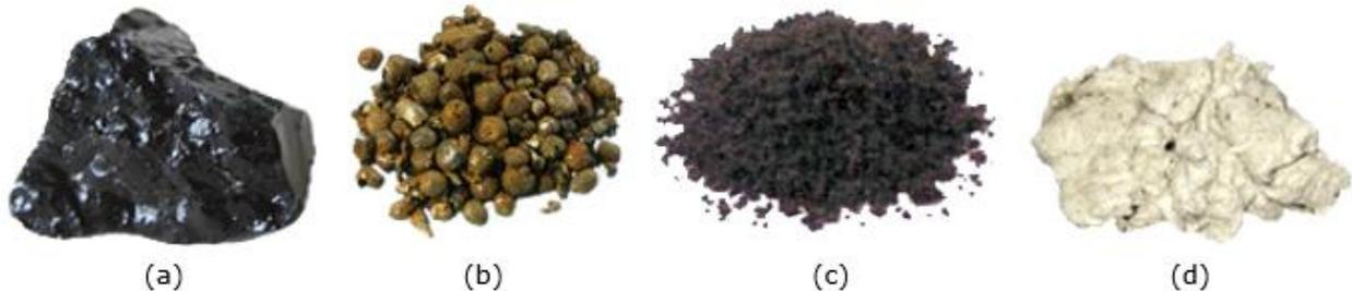
Figura 3.21: (a) Vitrificado enfriado al aire libre. (b) Nódulos de metal. (c) Vitrificado con agua. (d) Vitrificado lana mineral.
