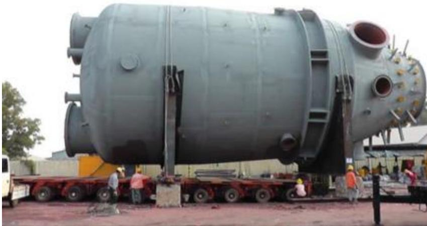
Figura 3.23: Reactor de gasificación Westinghouse G65.
