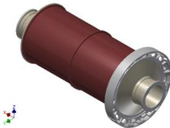
Figura 4.15 Modelo CAD del ensamble del molino visto desde el lado de entrada del material.
