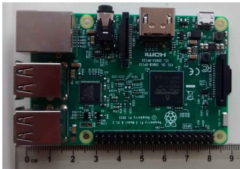
Ilustración 11: Computador de placa reducida Raspberry Pi 3 Model B, utilizado para controlar cámara Raspberry Pi.
