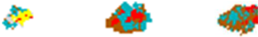
Figura 2.3: Imágenes texturales QemSCAN - sulfuros de Cu (rojo) con menos de 30% de superficie de liberación: izquierda - diseminado; centro - ocluido; derecha - asociación lateral. También se muestran: Qz-Feldspatos (celeste), Arcillas (café), Pirita (amarillo).
