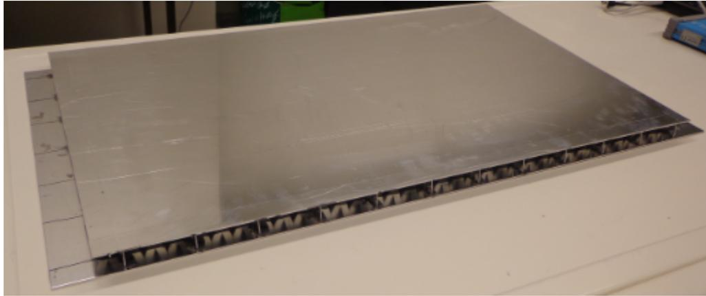
Figura 4.10: Panel tipo sándwich construido.
