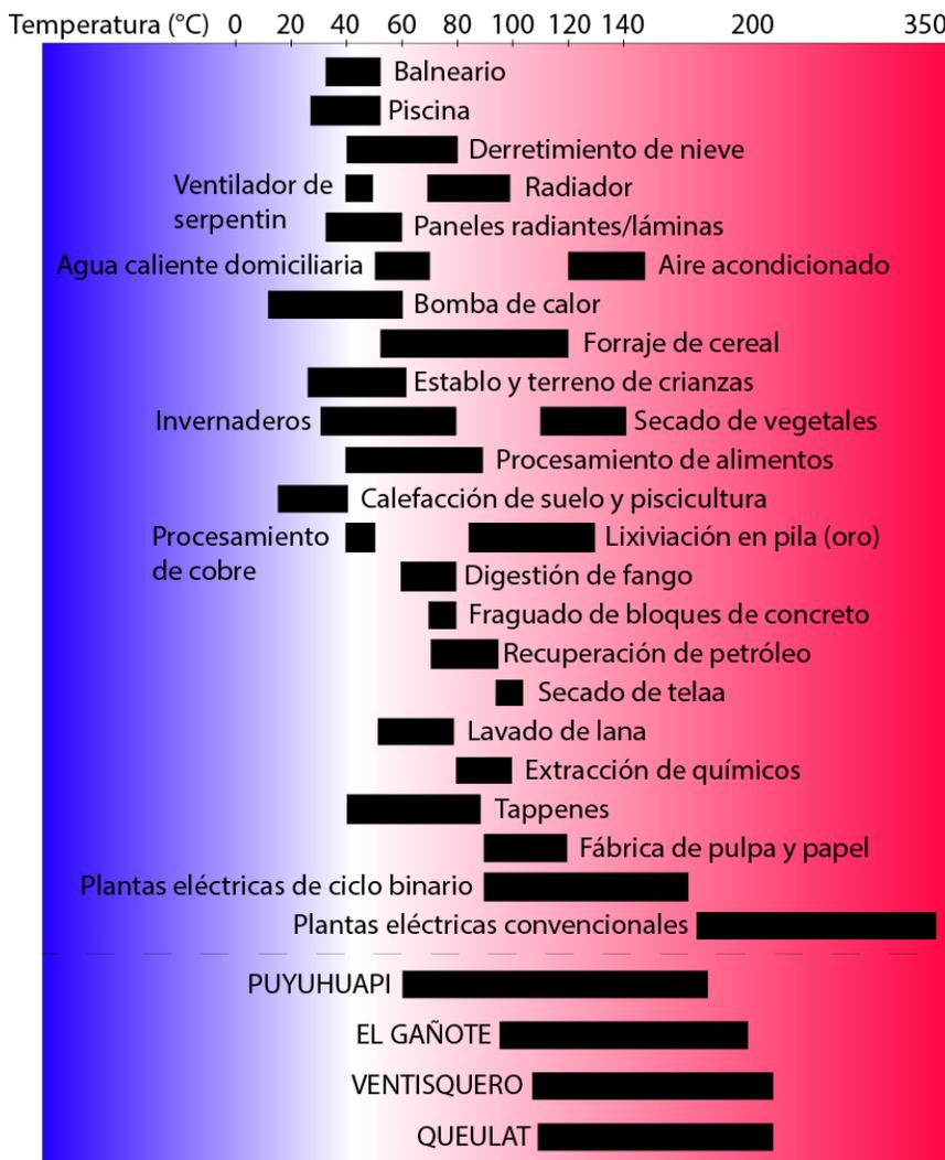
Figura 4-21 - Diagrama de Lindal con rango de temperaturas de las cuatro termas analizadas en este estudio. Modificado de sitio web Geothermal Energy.
