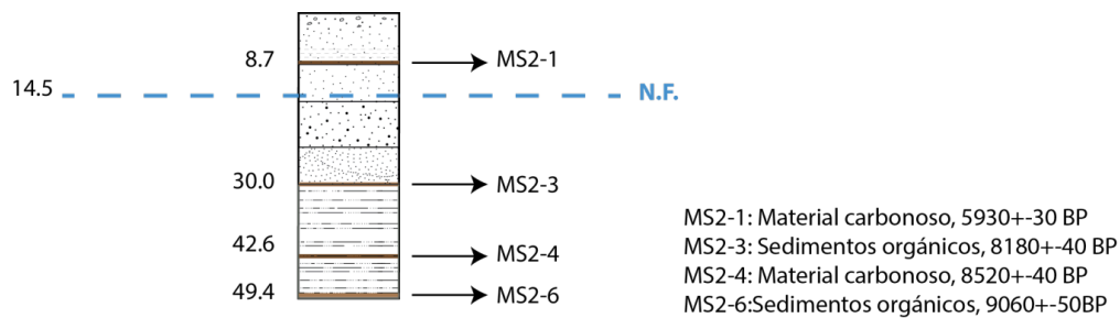
Figura P.4: Sondaje S-2 (50 m), indicando los niveles datados y su correspondiente edad convencional de radiocarbono (entregado por Beta Analytic Inc., Tamers M y Hood,D). Los números a la izquierda de la columna corresponden a la profundidad en metros. NF: nivel frático.
