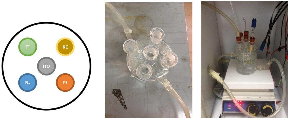
Figura 22: Imágenes de la celda utilizada y esquema de la disposición de electrodos.
