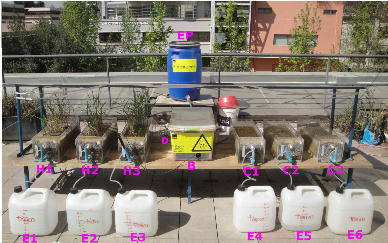
Figura 3.4: Instalación Experimental. H1, H2 y H3 corresponden a humedales plantados. C1, C2 y C3 corresponden a celdas de control. EP es el estanque principal de alimentación. E1 a E6 son los estanques de almacenamiento del efluente. B es donde se encuentra protegida la bomba y el medidor multiparámetro. D es el distribuidor (de la salida de EP a las seis mangueras pequeñas que alimentan cada celda).
