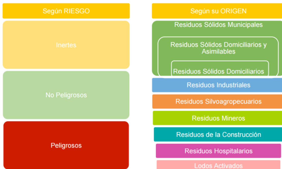
Figura 1. Clasificación de residuos en Chile. Fuente: Antecedentes del manejo y gestión de residuos en Chile
