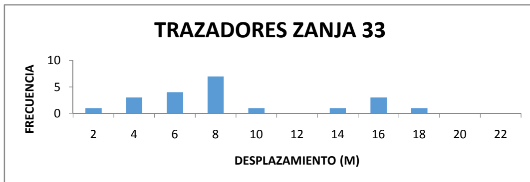
Figura 4-28: Detalle desplazamiento de los trazadores extraídos de la zanja 33.
