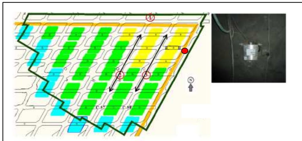
Figura 3-8: ubicación de lectores en el nivel de producción del bloque 2. Los números 1,2 y 3 indican el posicionamiento de los lectores.
