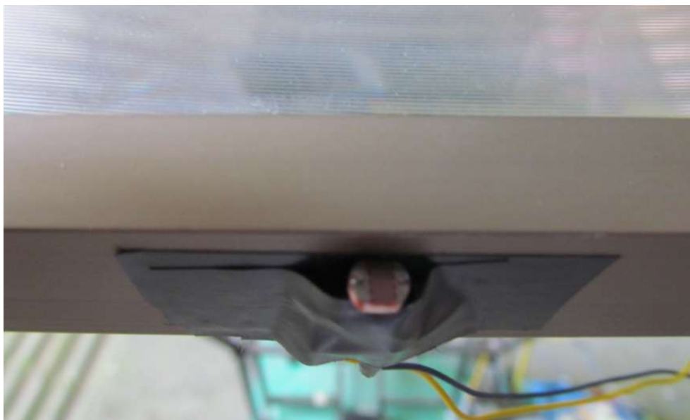
Figura 30 Fotorresistencia fijado al costado del lente
