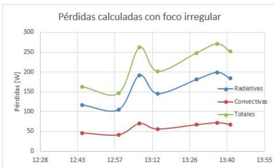
Figura 49 Pérdidas teóricas calculadas con foco irregular
