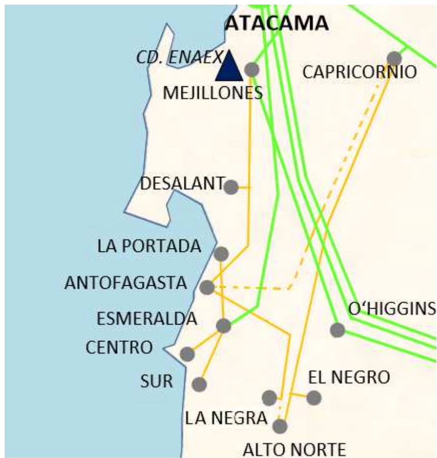
Figura 5.5 lineswitching "Antofagasta 110->Capricornio 110" y "La Negra 110->Alto Norte 110"
