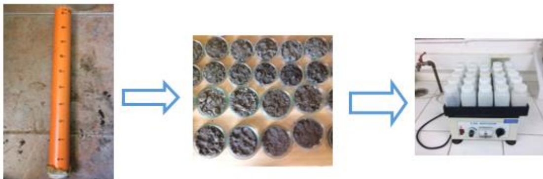
Figura 17. Esquema de extracción de compuestos en cortes de la columna.
