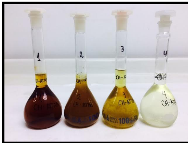
Figura 16. Lixiviado de la columna con Suelo Chicauma y pesticida Atrazina.
