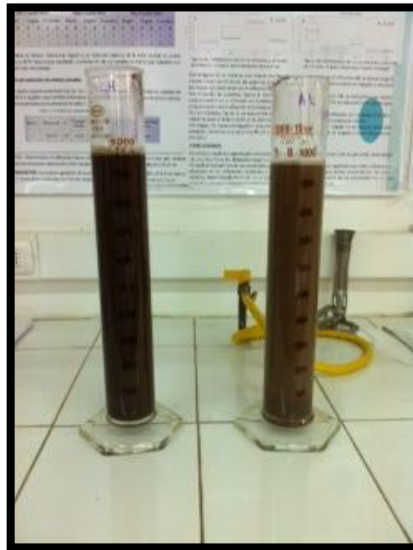
Figura 12. Velocidad de Sedimentación. Método de la pipeta.
