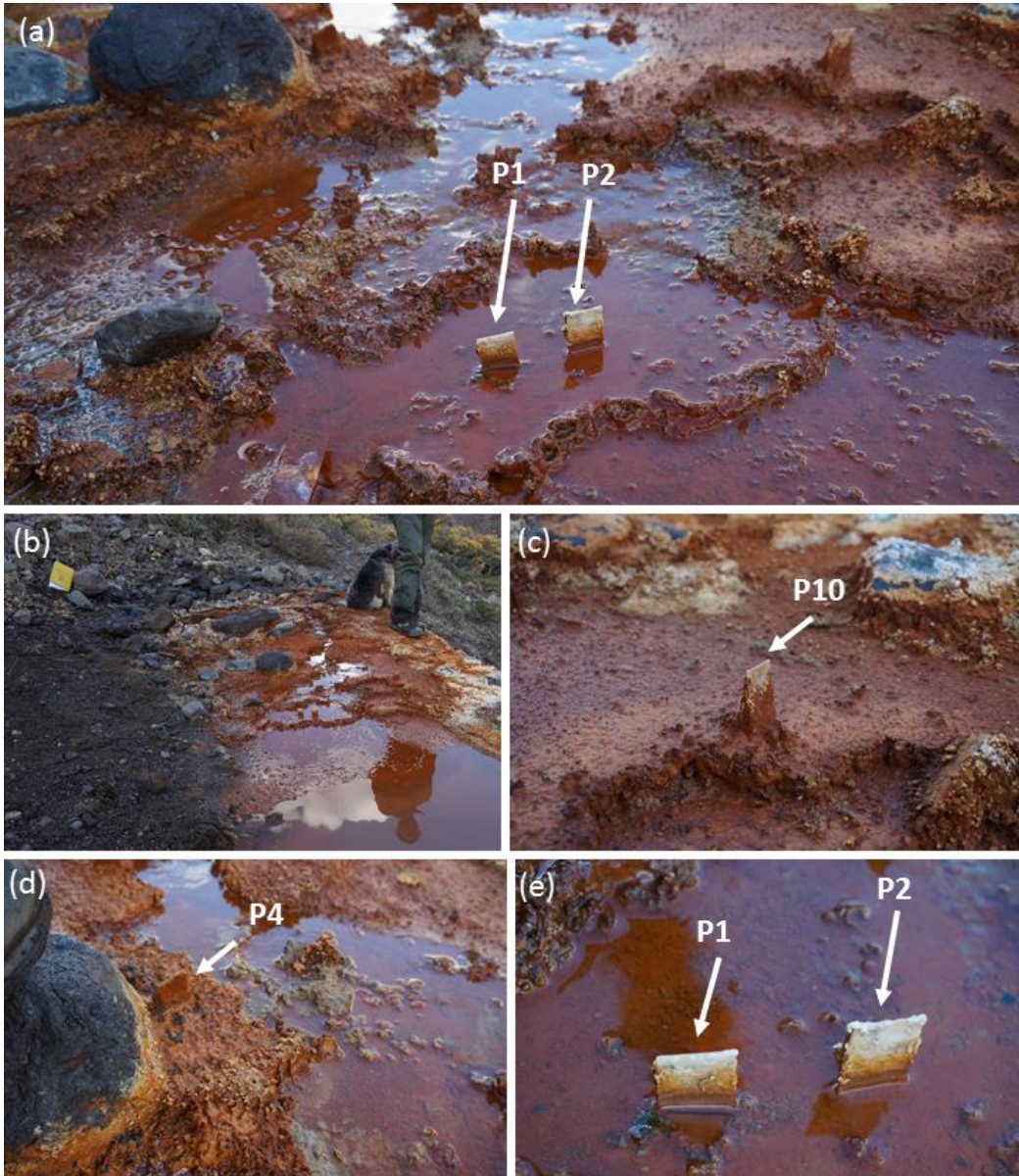
Figura 5.5.1: Placas con precipitado en la surgencia superior de Morales Poniente. Imagen tomada después de 91 días entre los meses de enero y abril.
