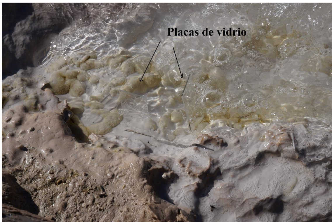
Figura 4.1.1: Placas de vidrio instaladas en depósito de travertino.
