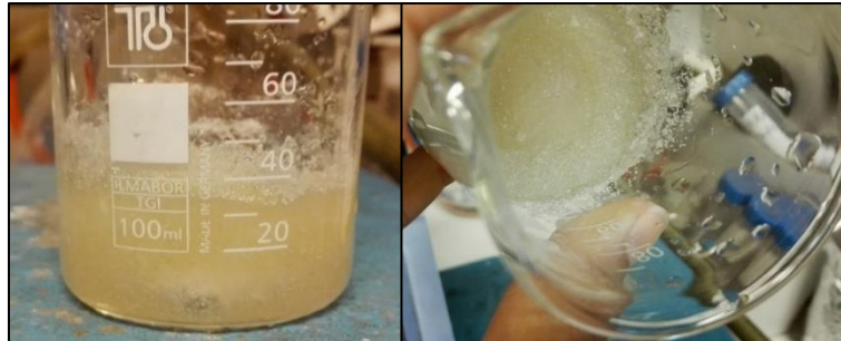
Ilustración 39: Mezcla obtenida de alginato/quitosano en razón 1:1 en agua destilada y ácido acético
