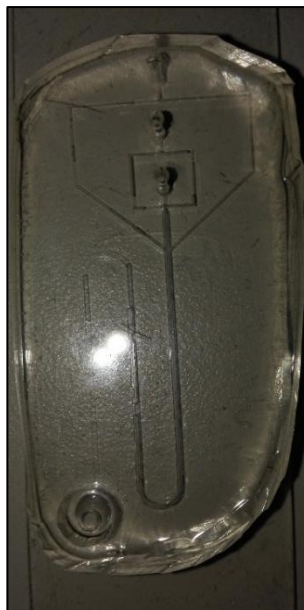
Ilustración 63: Microcanal unido a placa de microscopio con un modelo que permite un tiempo de residencia mayor de las microesferas
