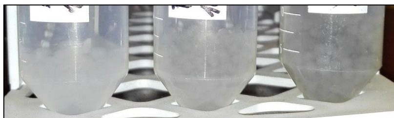
Ilustración 55: 88 días desde la preparación. A la izquierda esferas de alginato puro, en medio esferas recubiertas y a la derecha esferas blendas en agua destilada
