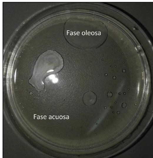
Ilustración 66: Dos fases generadas cuando caen las gotas desde el microcanal a una solución de quitosano
