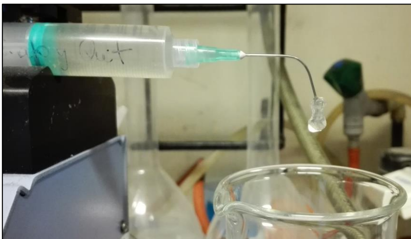
Ilustración 42: Generación de esferas, con la mezcla de alginato/quitosano en razón 1:1
