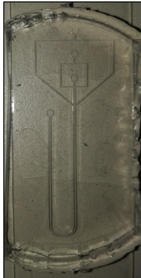
Ilustración 60: Microcanal unido a placa de microscopio
