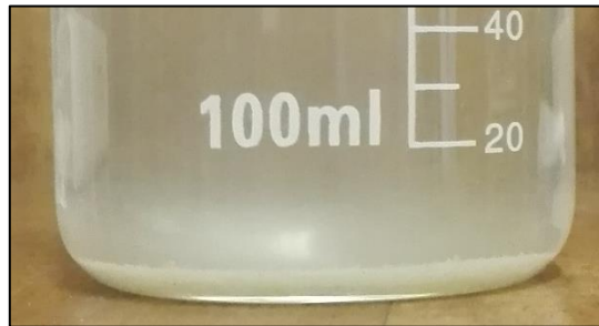
Ilustración 82: Prueba disolución de quitosano en alcohol isoamílico
