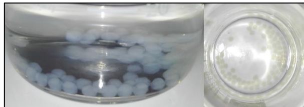
Ilustración 83: Esferas milimétricas de alginato cálcico en acetona
