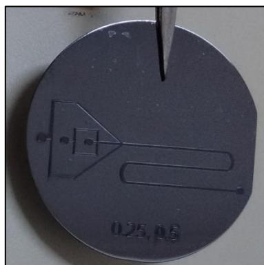
Ilustración 80: Modelo grabado en placa de silicio
