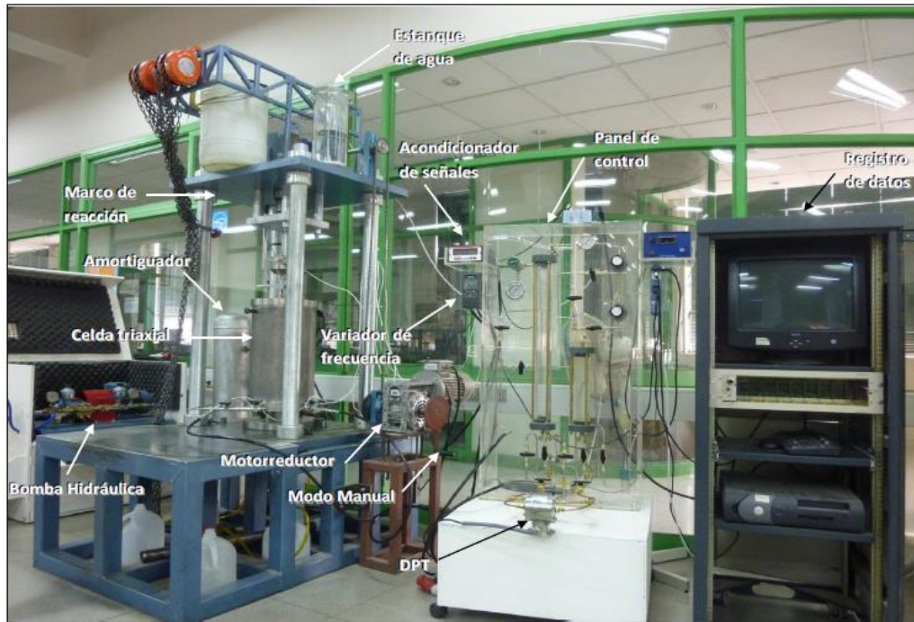
Figura 18 Componentes del equipo triaxial de altas presiones (Maureira, 2012)
