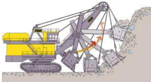
Ilustración B.8. Fase de excavación.
