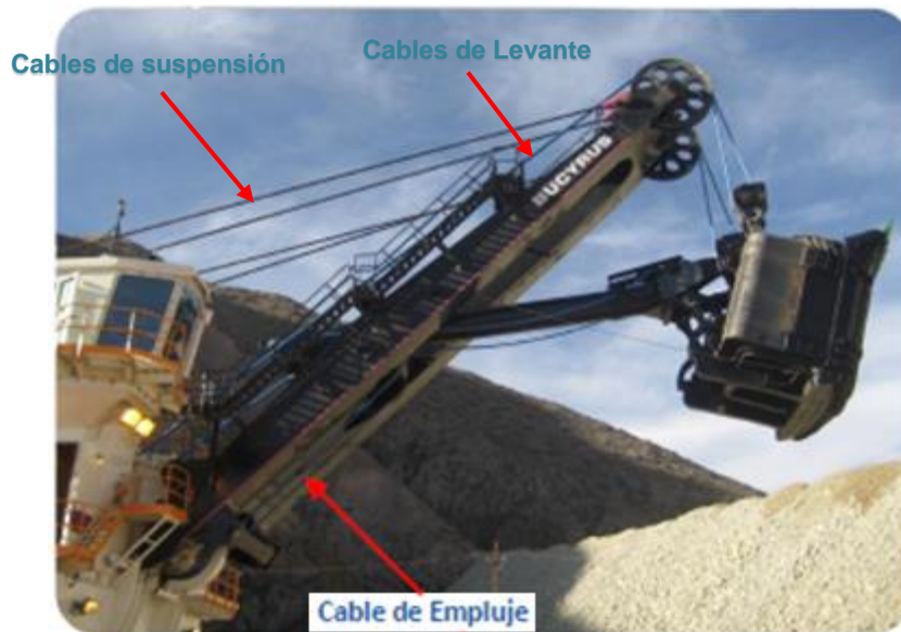
Ilustración B.6. Cables en Palas.
