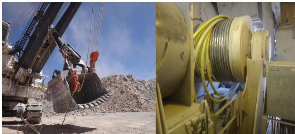
Ilustración 18. Corte cable en pala.
