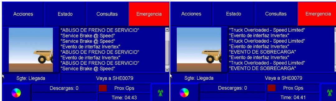
Ilustración 22. Visualización alarmas en la cabina del operador.
