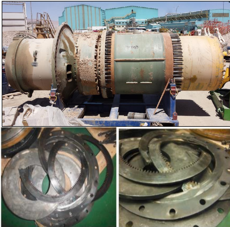
Ilustración 17. Desgaste motor de tracción (arriba) y paquetes de frenos (abajo).
