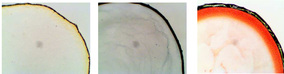
Figura 4: Separación y secado de cristales de colores amarillo, azul y rojo derivados de anilina negra comercial disuelta en agua. Imagen bajo microscopio (45X).
