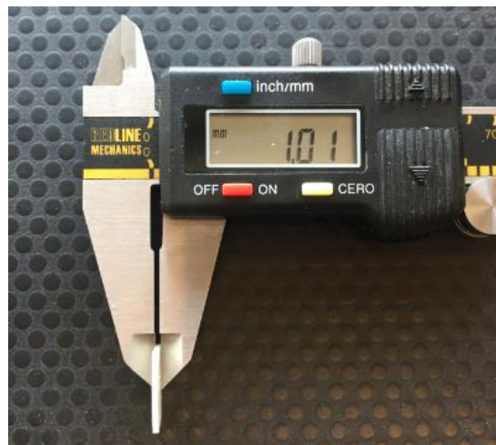
Figura 3. Pie de metro digital. Calibración de cuerpos de prueba.
