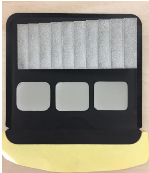
Figura 4. Cuerpos de prueba y Cuña Escalonada de Aluminio sobre película PSP.
