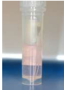
Figura 2. Vial de transporte con conos en 1 mL de medio de transporte RTF (Armijo, 2013).
