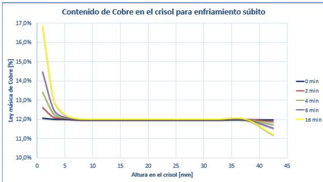
Figura 77 Ley de Cobre en el crisol para pruebas de sedimentación a diferentes tiempos (Enfriamiento súbito)
