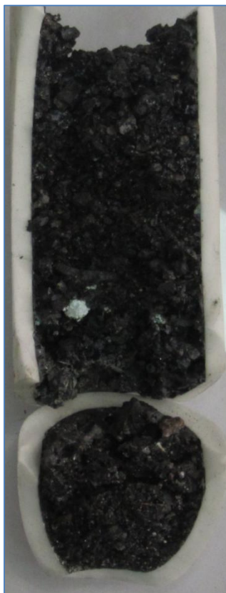
Figura 53 Escoria enfriada súbitamente luego de 8 minutos al interior del reactor (Caso base)
