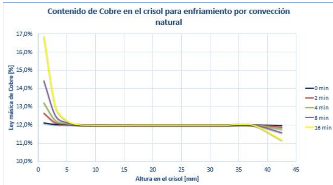
Figura 78 Ley de Cobre en el crisol para pruebas de sedimentación a diferentes tiempos (Enfriamiento por convección natural)
