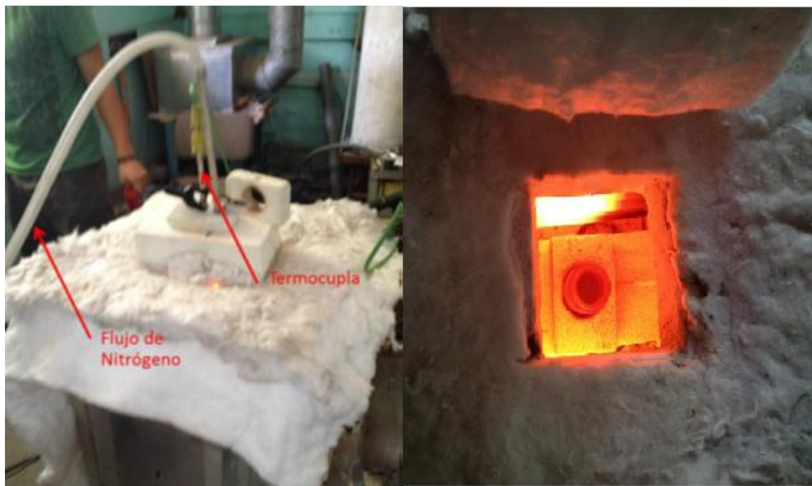
Figura 42 Fotos del arreglo experimental en laboratorio (a) Izq. Vista de la cámara de reacción, (b) Der. Vista al interior del crisol reactor
