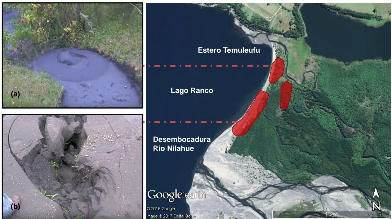
Figura 3. 2. Evidencias de licuación en las cercanías del Lago Ranco. Evidencia de licuación (a) al interior de la playa y (b) en la playa. (Obtenidas de youtube/José Ríos y GoogleEarth)
