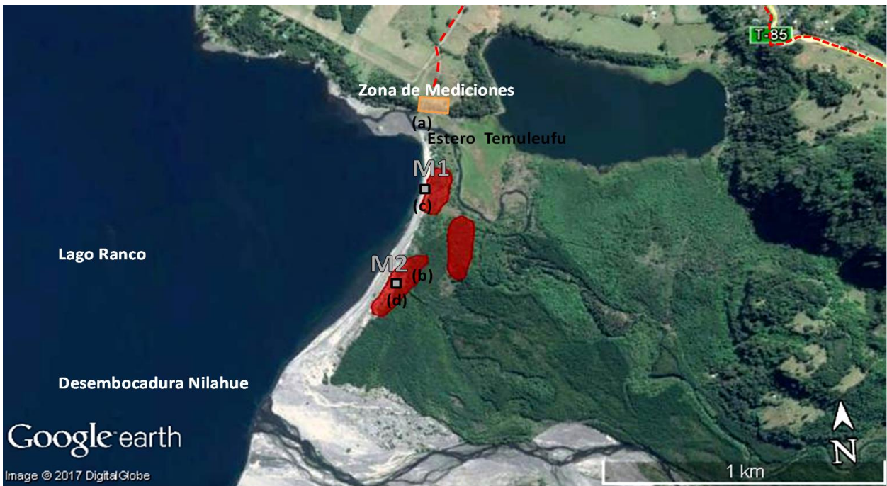
Figura 3. 9. Imagen en planta (Obtenida de GoogleEarth®) con las zonas donde posiblemente ocurrió la licuación (en rojo); los lugares donde se obtienen las muestras de suelo (M1 y M2) y las zonas de donde se toman fotos del terreno (a, b, c y d) expuestas en la Figura 3.10
