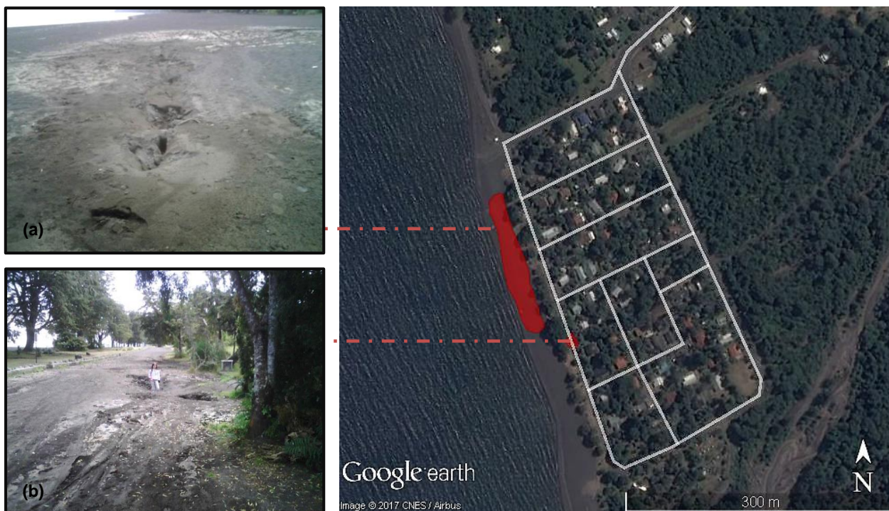
Figura 3. 4. Evidencia de licuación en el sector de Las Cascadas; (a) Asentamientos productos de licuación en la playa; (b) en el camino peatonal (Obtenidas de González, 2015; y GoogleEarth).
