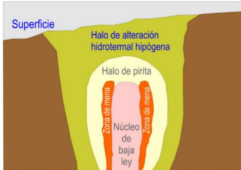
Ilustración 3.22. Esquema general de pórfido indicando las zonas de mena. (Lowell & Gilbert, 1970).
