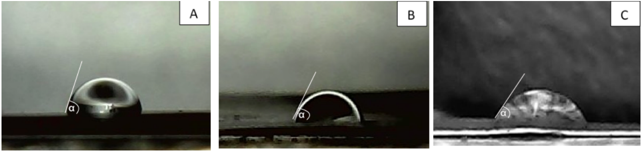
Figura 4.7: Ángulo de contacto de las membranas. A) PA B) PA/PSf C) PA( TiO_2 1.5 %)/PSf.
