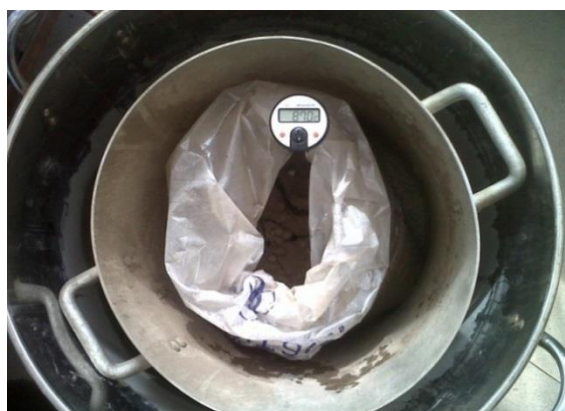
Figura 5. Tratamiento de suelo con altas temperatura.
