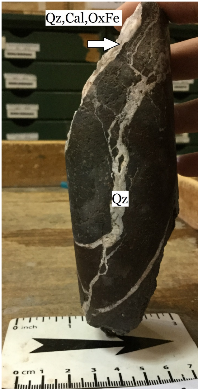
Figura 47. Fotografía de la muestra CL-CP-31. Presenta dos tipos de vetillas. La principal con Qz, Cal y OxFe, y un set con Qz. La escala está en centímetros.
