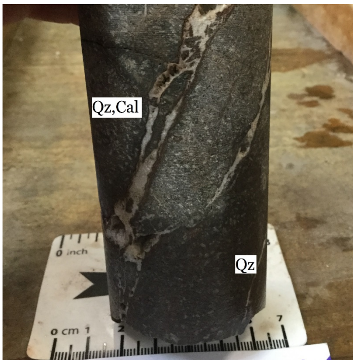
Figura 46. Fotografía de la muestra CL-CP-28. Presenta dos tipos de vetillas. La principal con Qz y Cal, y una secundaria con Qz. La escala está en centímetros.
