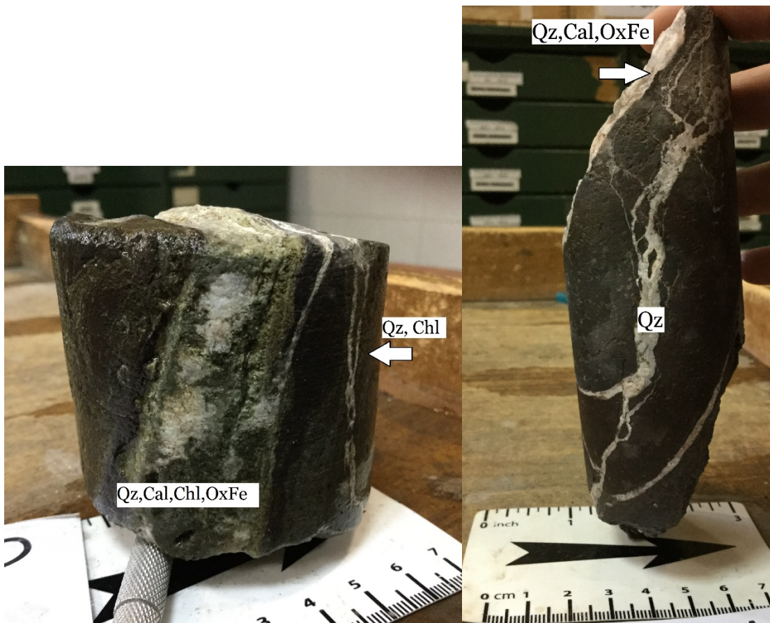
Figura 16. Fotografías del sondaje con vetillas con Qz o Cal y otros minerales. Izquierda, muestra CL-CP-20. Derecha, muestra CL-CP-31 .La escala está en centímetros. Cal: calcita. Chl: clorita. OxFe: óxidos de hierro. Qz: cuarzo.
