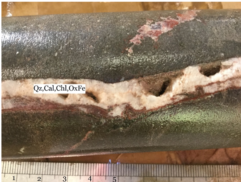
Figura 44. Fotografía de la muestra CL-CP-50. La vetilla presenta Qz, Cal, Chl y OxFe. La escala está en centímetros.
