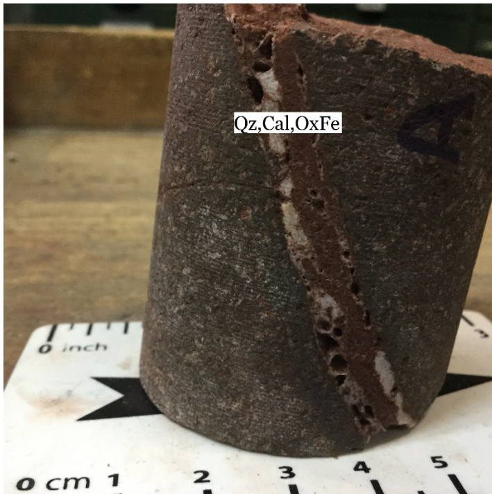
Figura 40. Fotografía de la muestra CL-CP-24. La vetilla presenta Qz, Cal y OxFe. La escala está en centímetros.
