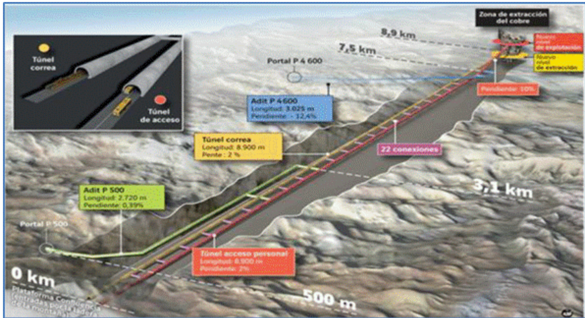
Figura N° 2-4: Túnel Acceso Principal y Túnel Correa.
