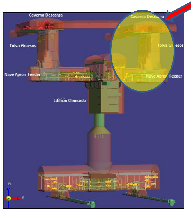
Figura N° 6-5: Tolvas de Descarga en Configuración Planta Chancado.
