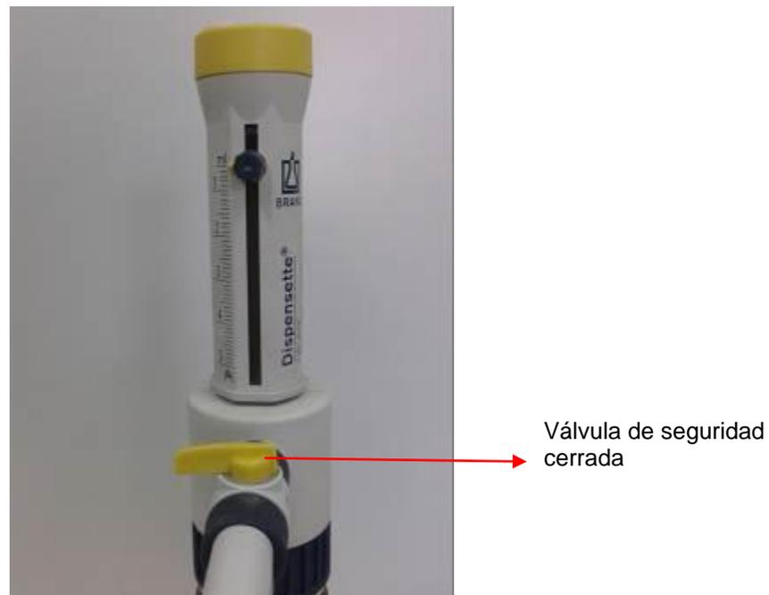
Fig. 4: Cierre de válvula de seguridad
