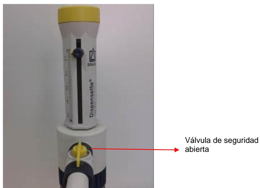
Fig. 5: Válvula de seguridad abierta
