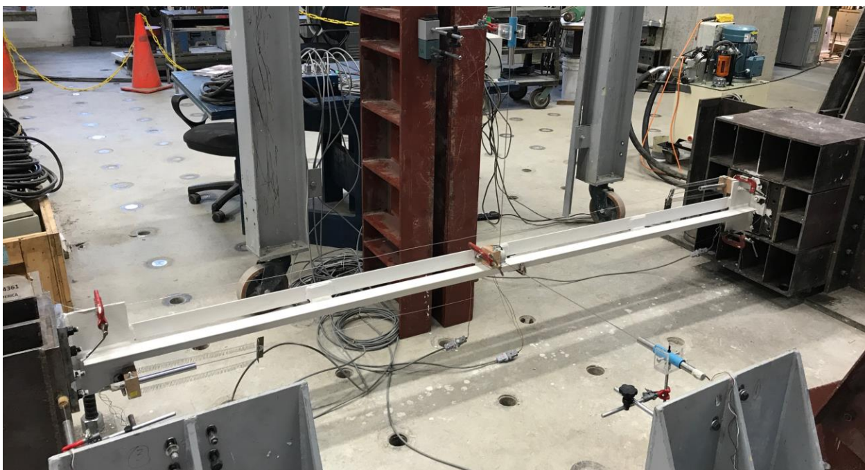
Figura 6.17: Perfil XL largo monotónico listo para ser ensayado.
