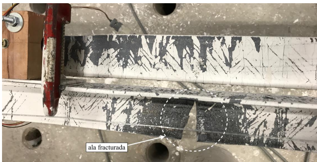
Figura 6.25: Fractura del ala del ángulo superior del perfil XL largo cíclico.
