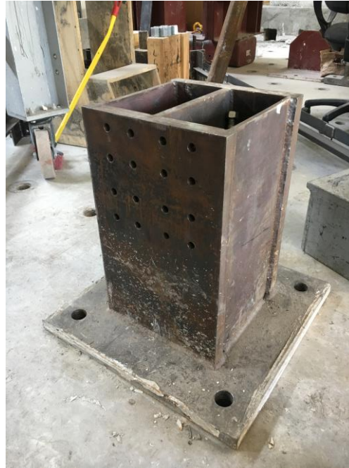
Figura 4.9: Apoyo simple del ensayo.
