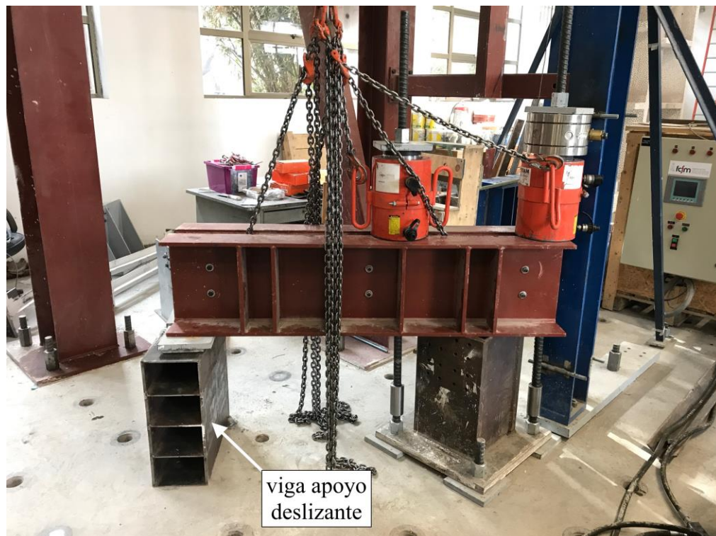
Figura 4.10: Sistema de tensado para las barras del apoyo simple en su posición para las riostras más largas.
