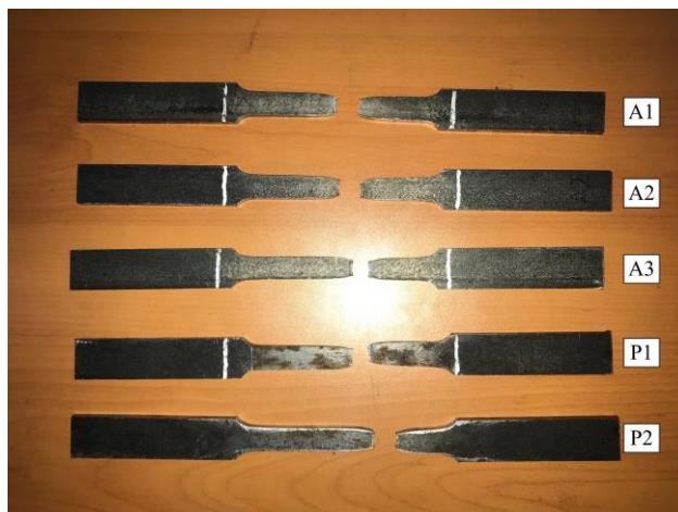
Figura 5.4: Probetas fracturadas de los ensayos de tracción.
