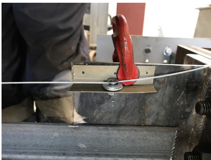
Figura 4.20: Ángulo de aluminio de soporte para el cable de los LVDT's longitudinales.
