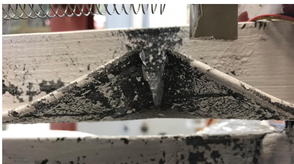
Figura 6.39: Desgarramiento del ala horizontal del ángulo superior del perfil XL corto cíclico.
