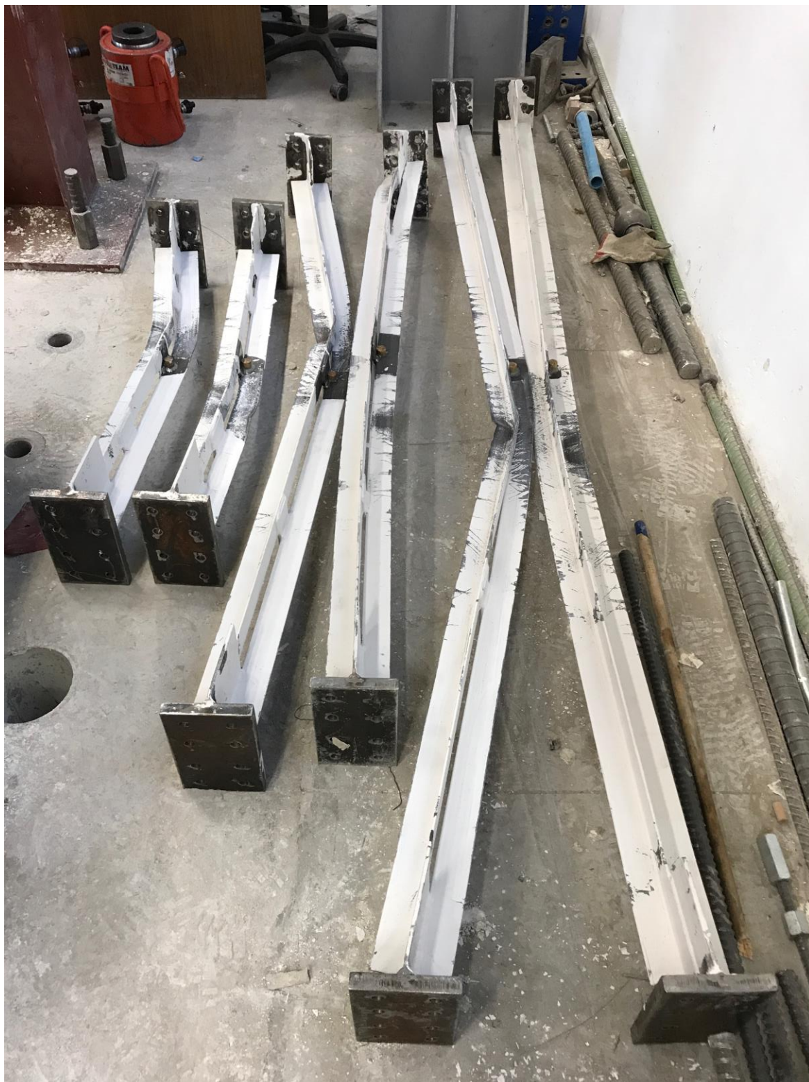
Figura 6.43: Perfiles XL ensayados: el de la izquierda en cada par corresponde al espécimen cíclico.
