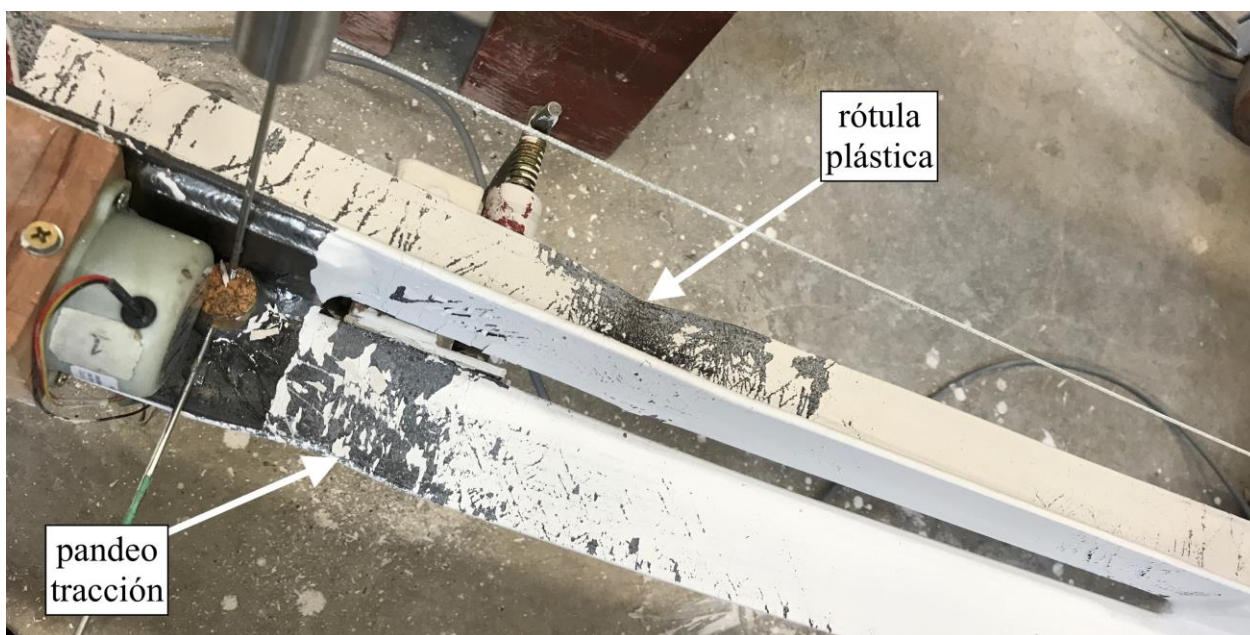
Figura 6.12: Ubicación relativa de la rótula plástica y el pandeo en tracción del perfil XL intermedio cíclico.
