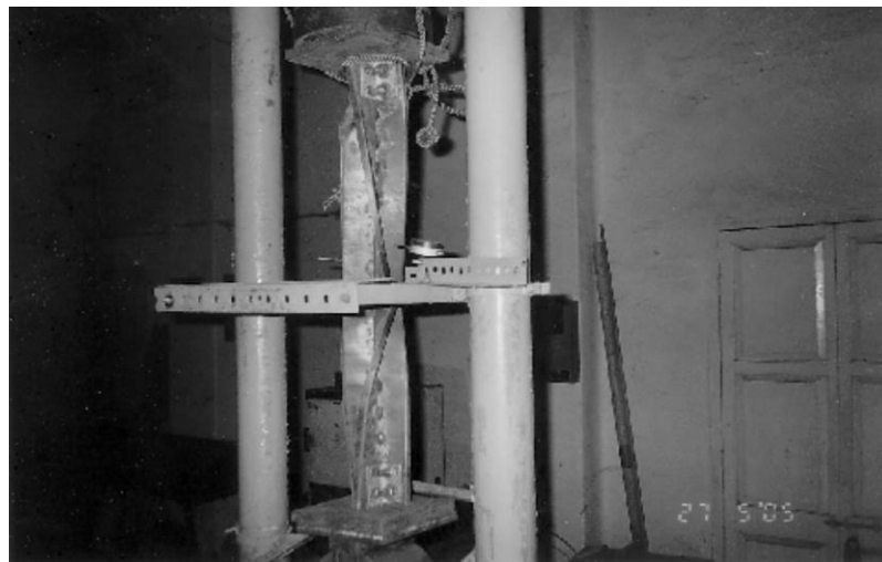
Figura 2.9: Pandeo torsional de un perfil XL con conexión apertada (Vishnuvardhan & Samuel Knight, 2008).
