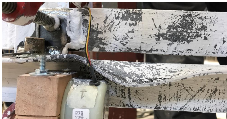
Figura 6.37: Pandeo en tracción del perfil XL corto cíclico.
