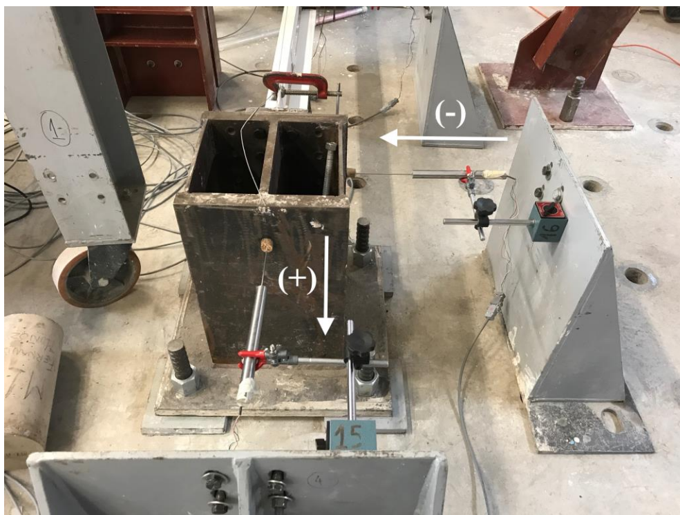
Figura 4.25: Signos para los datos de los LVDT's del lapoyo simple.
