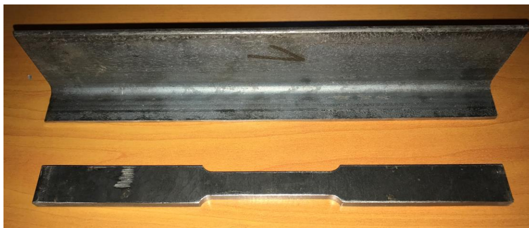
Figura 5.2: Probeta de ángulo y tramo original utilizado para la fabricación.
