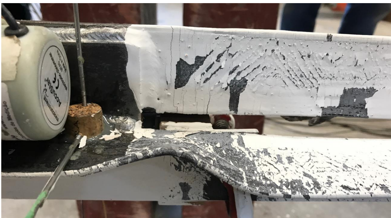
Figura 6.13: Pandeo en tracción del perfil XL intermedio cíclico. Notar que el perfil se encuentra prácticamente recto.
