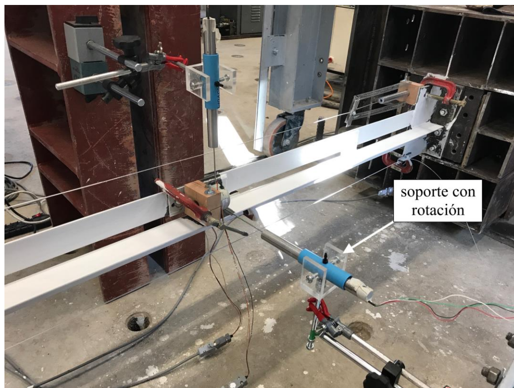
Figura 4.14: Cambio de soporte para permitir rotación del LVDT en el ensayo cíclico de la riostra intermedia (vista desde el norte del perfil).
