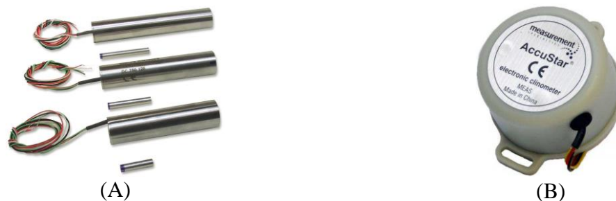
Figura 4.11: Instrumentos de medición: (A) LVDT's; (B) inclinómetro.
