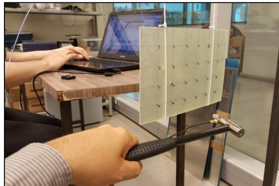
Figura N° 4.5: Martillo modal golpeando a placa experimental
