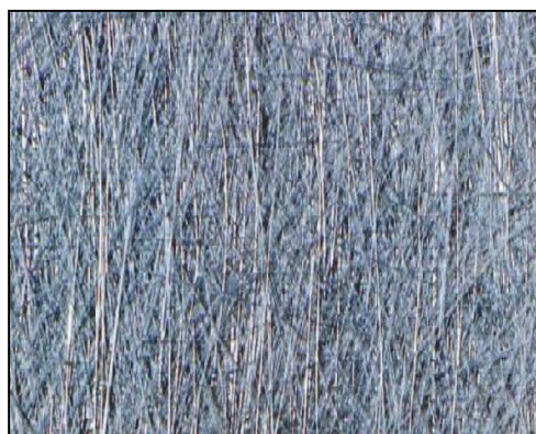
Figura N° 3.5: Formato refuerzo MAT 450 [3]
