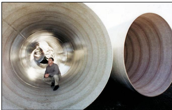
Figura N° 3.12: Ductos creados por el proceso Filament Winding [1]
